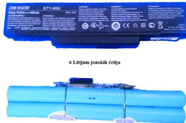
Slika 2.1. Rastavljanje plastičnog kućišta baterije na pojedinačne litijum-jonske ćelije
