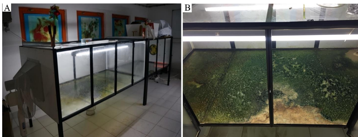
Slika 21. Eksperimentalna komora (A) sa razvijenim cijanobakterijskim biofilmom (B)
