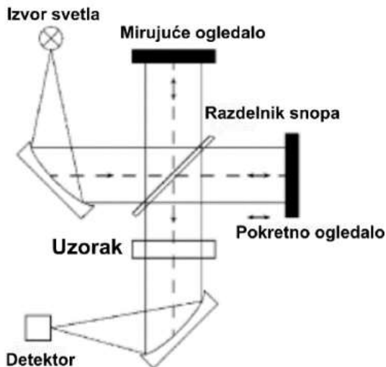
Slika 14. Mišelsonov interferometar. Preuzeto i modifikovano iz (Friedrich and Hildebrandt 2008).
