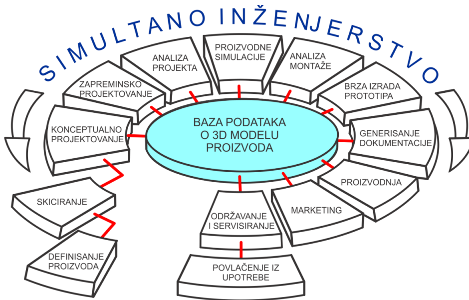
Slika 2.11 Aktivnosti razvoja proizvoda u okviru simultanog inženjerstva
