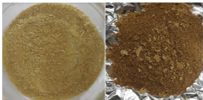
Слика 16. Изглед клијанаца сушених лиофилизацијом (лево) и сушених у струји топлог ваздуха (десно)
