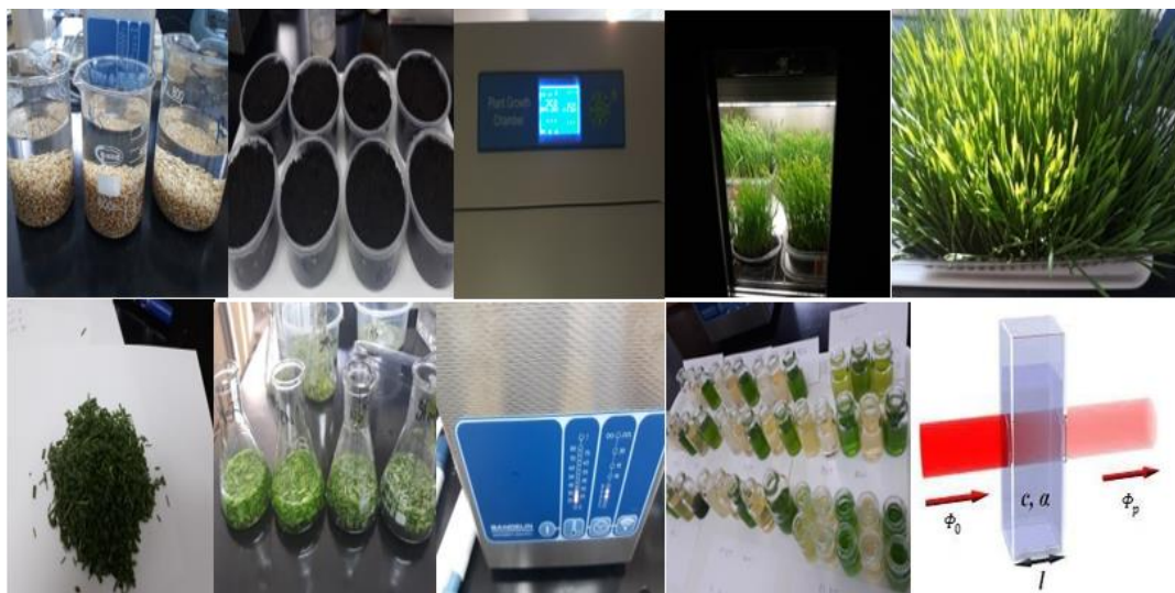
Слика 18. Припрема узорка пшеничне траве: испирање семена са \text{H}_2\text{O}_2 , засејавање, развој траве у клијалишту (горе), припрема траве за екстракцију, ултразвучна екстракција и спектрофотометријска анализа добијених екстраката (доле)
