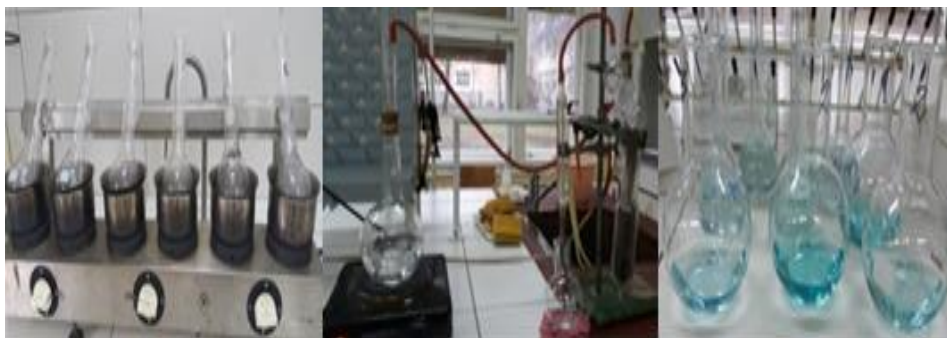
Слика 21. Одређивање садржаја протеина методом по Кјелдалу
