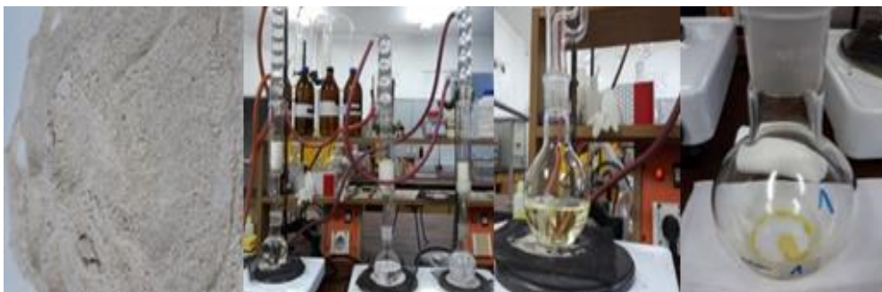
Слика 23. Поступак и апаратура за одређивање садржаја масти
