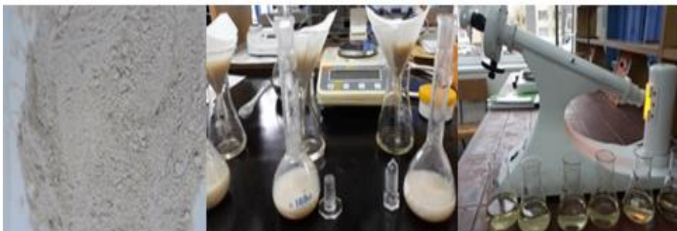
Слика 22. Поступак и апаратура за одређивања скроба
