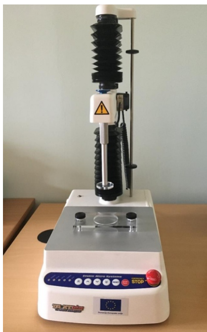
Slika 3. Analizator teksture TA.XT Plus sa alatom „A/BE disk za povratnu ekstruziju“ (Stable Micro Systems Ltd., Velika Britanija)
