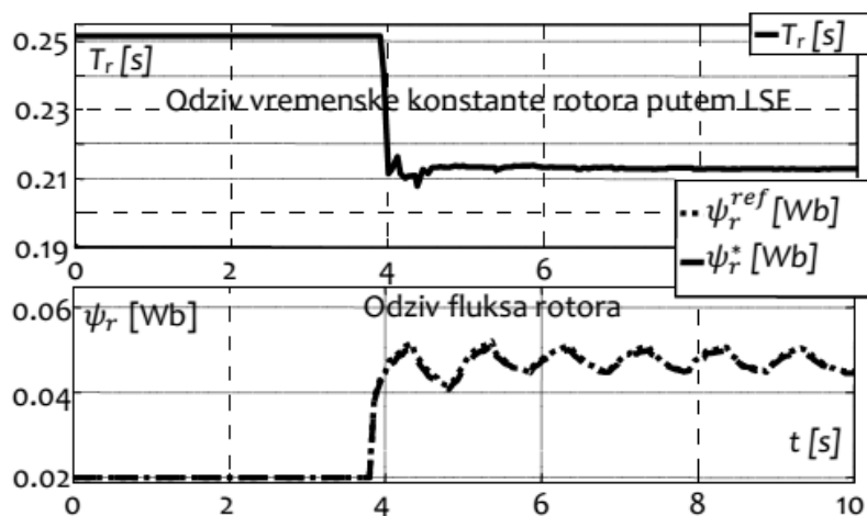
Slika 7.4. Odziv vremenske konstante rotora AM i i uporedni prikaz modifikovanih flukseva rotora i greške predikcije LSE neopterećenog pogona AM pri n=1500 o/min kada su izraženi efekti zasićenja magnetnog kola
