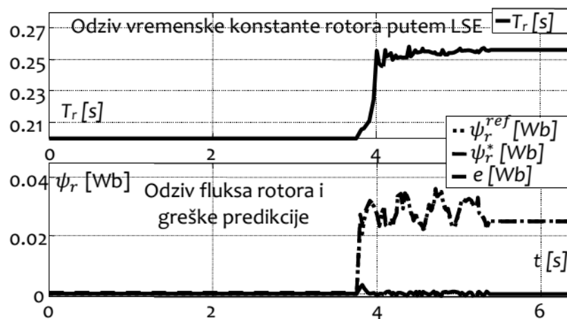
Slika 7.8. Odziv vremenske konstante rotora AM i i uporedni prikaz modifikovanih flukseva rotora i greške predikcije LSE opterećenog pogona AM pri n=100 \text{ o/min}
