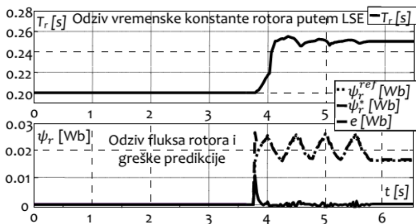
Slika 7.6. Odziv vremenske konstante rotora AM i i uporedni prikaz modifikovanih fluksa rotora i greške predikcije LSE opterećenog pogona AM pri n=5000\ o/min
