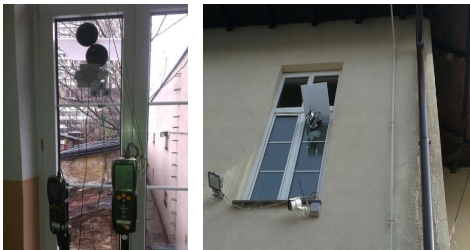
Слика 4.12 Приказ мерења топлотног флуksа и температура за стакло (слика лево - унутрашње мерење, слика десно - спољашње мерење)
