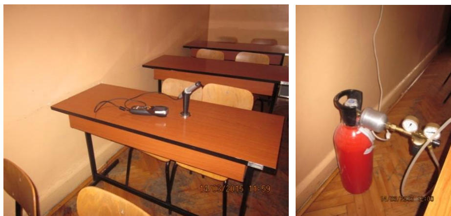
Слика 4.18 Приказ мерења параметара потребних за прорачун природног броја измена ваздуха у згради
