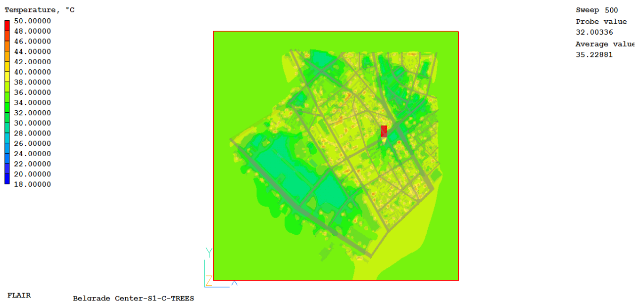
Слика 6.4 Поље температуре ваздуха на висини 1,85 метара за случај S1-C
