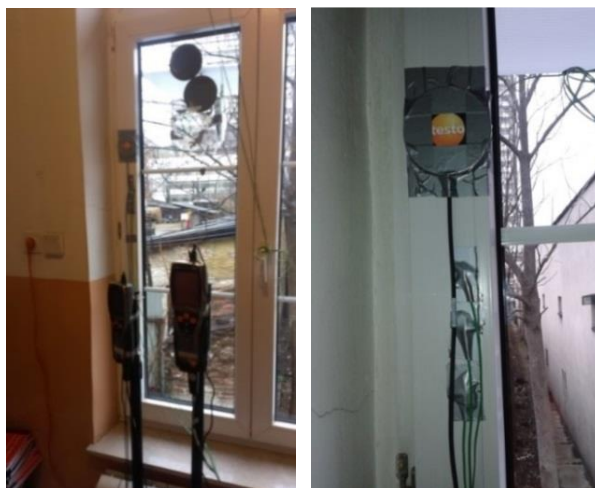
Слика 4.13 Приказ мерења топлотног флуksа и температура за рам
