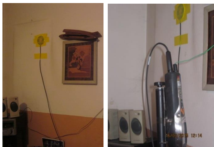
Слика 4.16 Приказ мерења топлотног флукса и температура за спољни зид у сутерену
