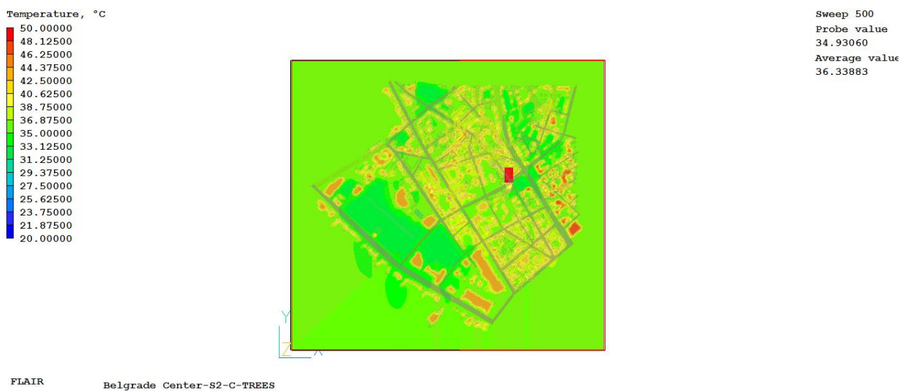
Слика 6.9 Поље температуре ваздуха на висини 1,85 метара за случај S2-C
