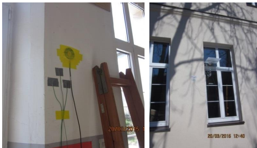
Слика 4.15 Приказ мерења топлотног флукса и температура за спољни зид дебљине 55 цм (слика лево - унутрашње мерење, слика десно - спољашње мерење)
