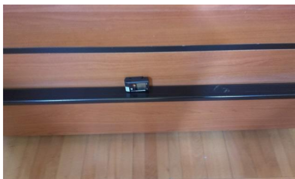
Слика 4.9 Testo-174Н постављен испод клупе (Н=50 цм)
