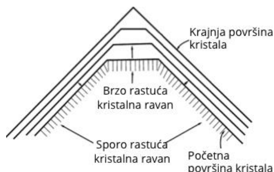
Слика 4.32. Схематска илустрација раста кристала која приказује како брзо растуће равни нестају, док споро-растућа равна остаје (Bockris i dr. , 2000; Nikolić i Popov , 2014; Nikolić i dr. , 2013b)
