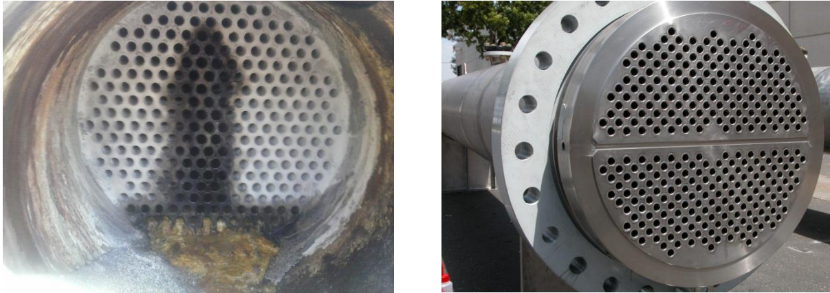
Slika 15. Razmenjivač toplote sa snopom cevi u omotaču nakon 3 meseca rada (levo) i izgled novog razmenjivača toplote sa snopom cevi u omotaču (desno)
