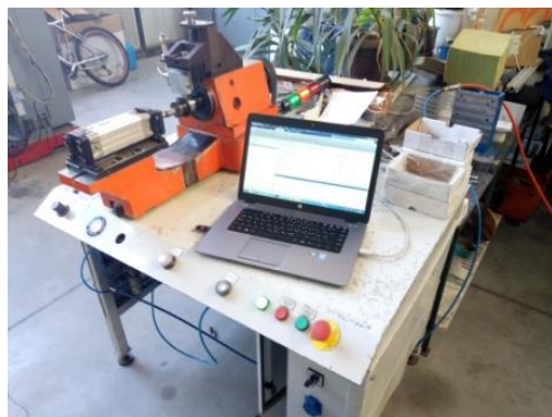
Slika 5.3. Eksperimentalni uređaj za merenje vibracija kotrljajnih ležaja
