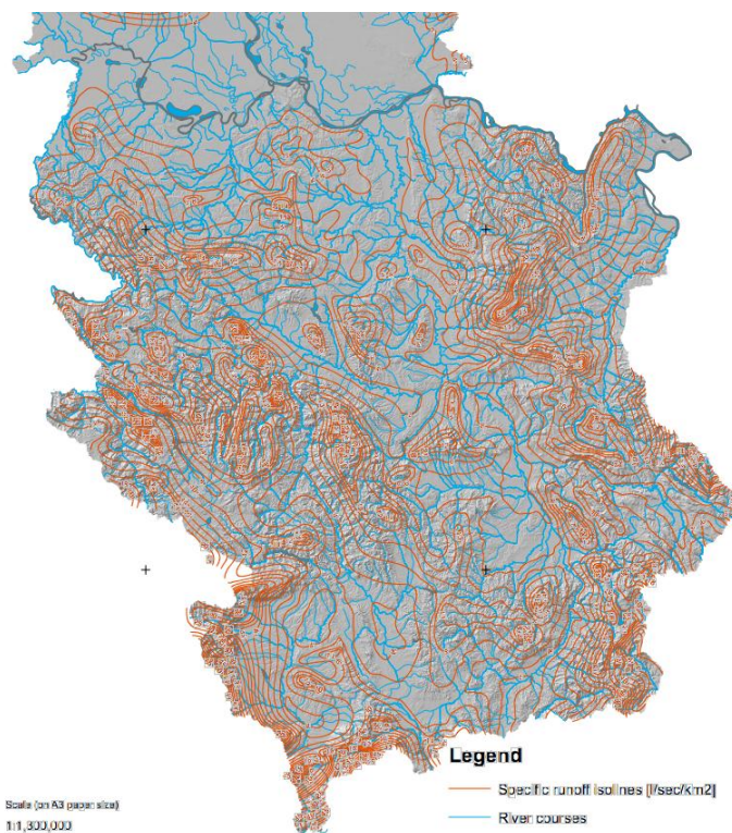
Слика 4.12 Дигитализована карта изолинија модула специфичног отицаја [35]
