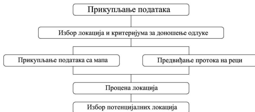
Слика 3.12 Алгоритам за идентификацију погодних профила за одређивање потенцијалних локација [61]
