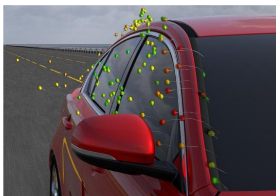
Slika 3.19 – Prelazak fluidne struje preko A stuba vozila [38]
