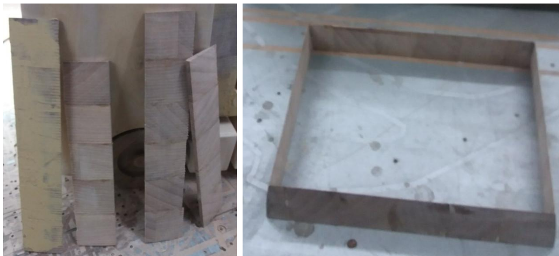
Slika 7.14 - Aerodinamički dodatak iz poluprikolice pre i posle spajanja
