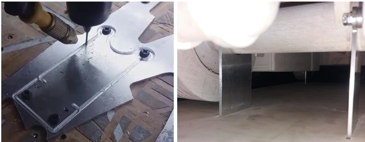
Slika 7.16 - Nosači za pričvršćenje modela na dasku
