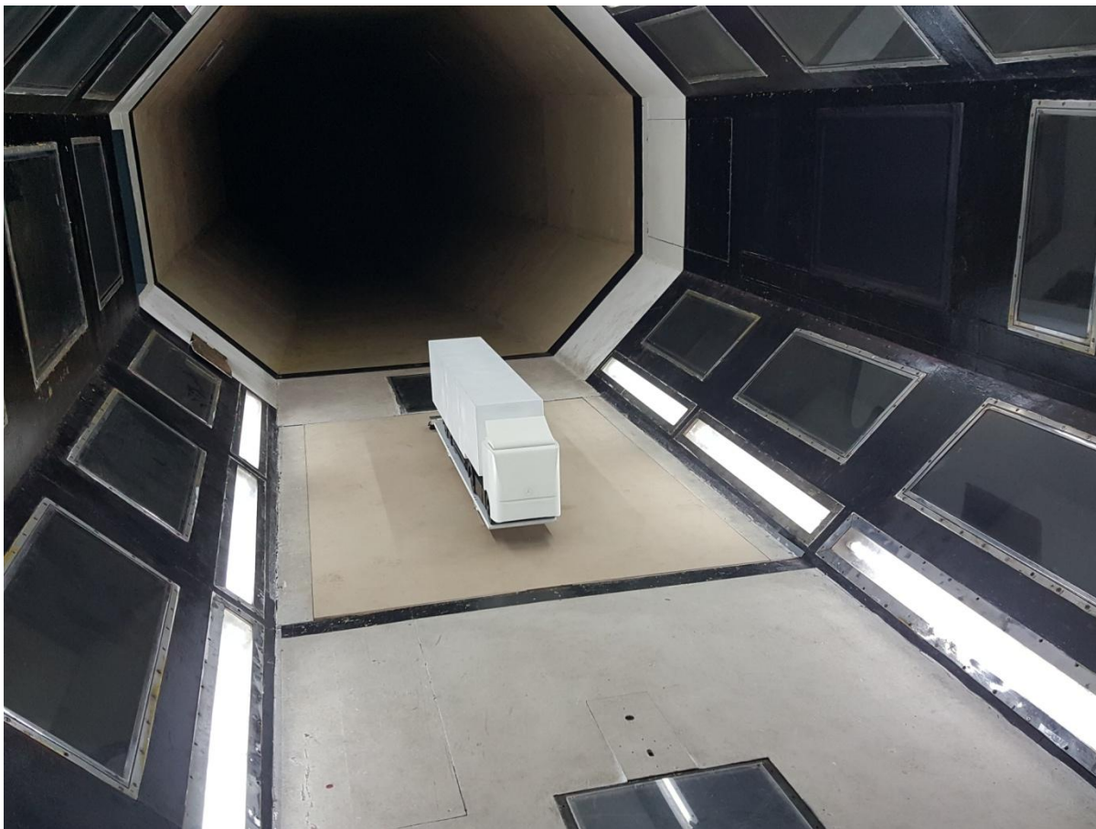
Slika 7.24 - Ispitivani model u vazdušnom tunelu, I konfiguracija
