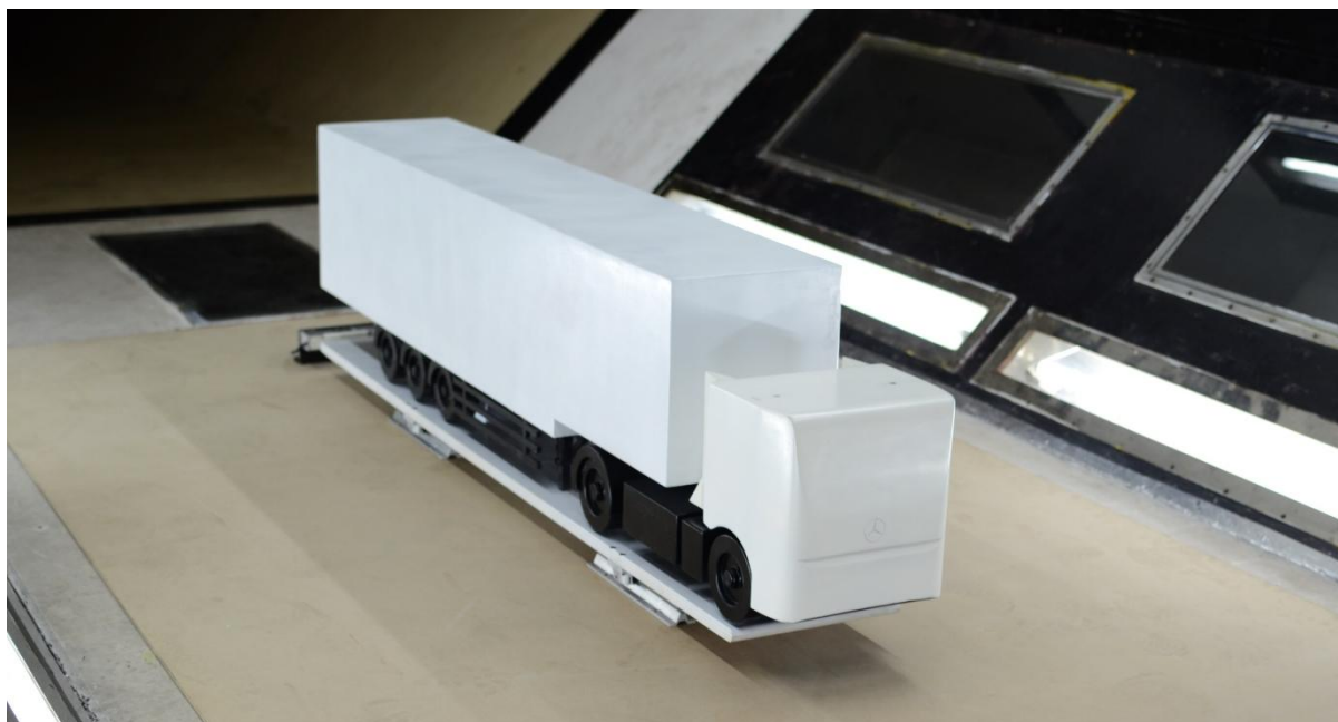
Slika 7.33 - Ispitivani model u vazdušnom tunelu, IV konfiguracija
