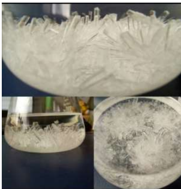
Slika 3.2. Kristali sintetisanog karbohidrazida (dhO)
