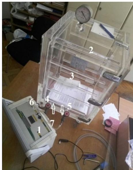
Slika 11.2 (1) Aktivni uređaj RTM 1688-2, (2) komora od debelog pleksiglasa zapremine 30 l, (3) uzorak, (4) i (5) slavine za puštanje radonskog gasa u merni sistem, (6) i (7) plastične cevi. Smer kruženja radonskog gasa kroz sistem obilježen je strelicama.
