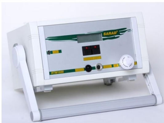
Slika 3.11 Izgled uređaja RTM 1688-2 za merenje koncentracije aktivnosti radona, proizvođača Sarad GmbH, Germany.
