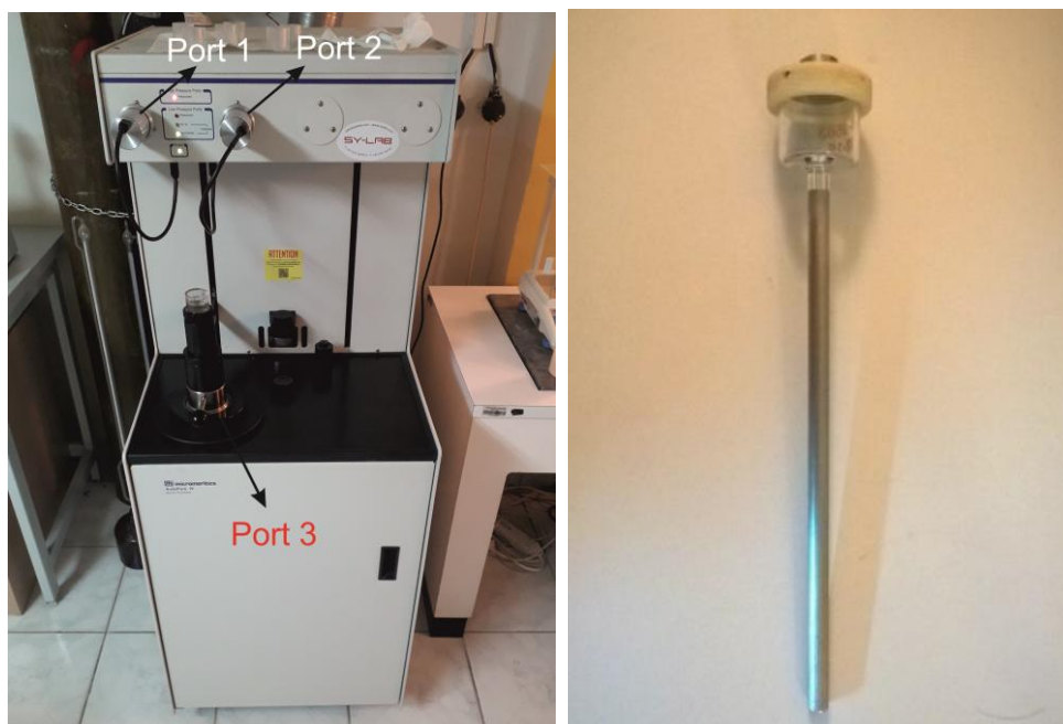
Slika 5.9 Izgled Autopore IV 9500 uređaja za živinu porozimetriju (levo) penetrometar za živinu porozimetriju (desno).
