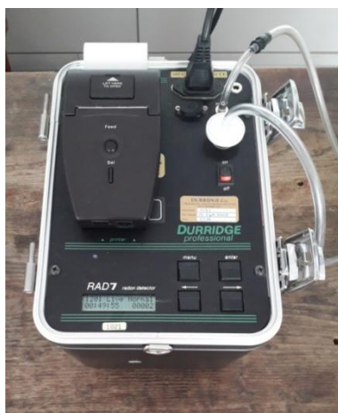
Slika 3.8 Alfa spektrometar RAD7 proizvođača DurrIDGE Company, USA.
