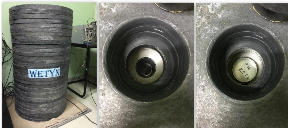
Slika 3.12 Izgled 9'' x 9'' NaI(Tl) gama spektrometra oblika jame u Laboratoriji za ispitivanje radioaktivnosti uzoraka i doze jonizujućeg i nejonizujućeg zračenja na Departmanu za fiziku u Novom Sadu.
