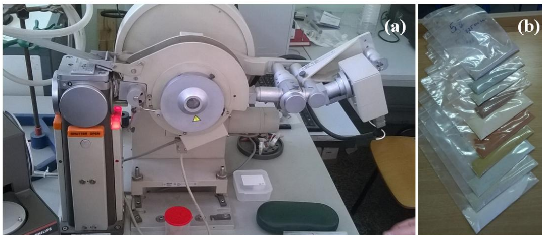
Slika 5.4 (a) Difraktometar Philips, PW1820/00 korišćen za mineralošku analizu građevinskih materijala u ovoj studiji, (b) uzorci građevinskih materijala pripremljeni za XRD analize.
