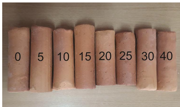
Slika 10.2 Opeka sa različitim udelom fosfogipsa (0 – 40 %), pečena na 1000 °C.
