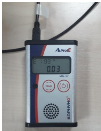
Slika 3.10 Izgled uređaja AlphaE korišćenog za merenje koncentracije aktivnosti radona, proizvođača Saphymo GmbH, Nemačka.
