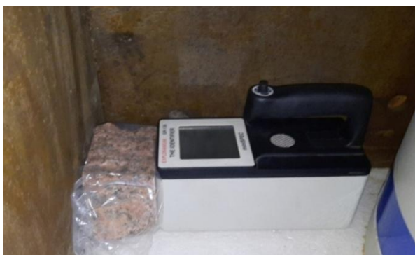
Slika 8.10 Merenje jačine doze gama zračenja od balk uzorka granita dozimetrom Exploranium u kontaktnoj geometriji u gvozdenoj zaštiti debljine 25 cm.
