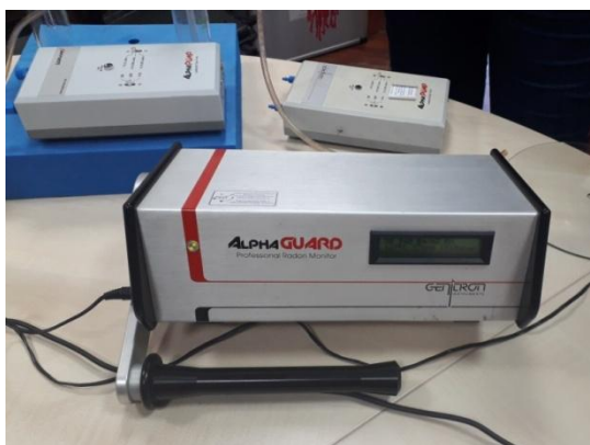
Slika 3.9 Izgled AlphaGuard uređaja korišćenog za merenje koncentracije aktivnosti radona. Saphymo GmbH, Nemačka.
