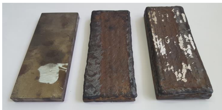
Слика 7.7 Изглед плоче пре наваривања (лево) и наварених плоча (средина и десно)
