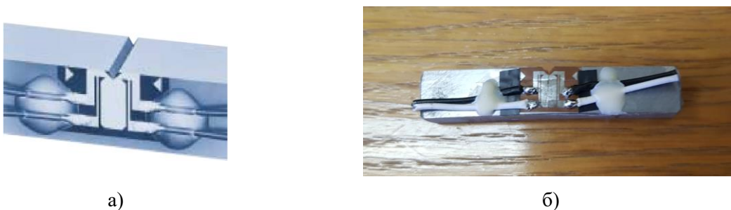
Слика 7.115 Схематски приказ мерне траке (а) и физички изглед узорка са мерном траком (б)
