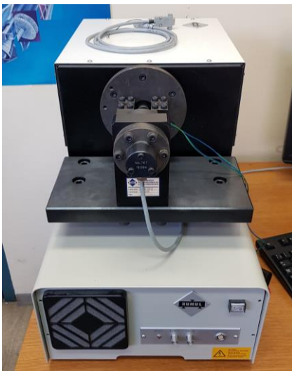
Слика 7.117 Изглед узорка постављеног на уређај RUMUL CRACTRONIC
