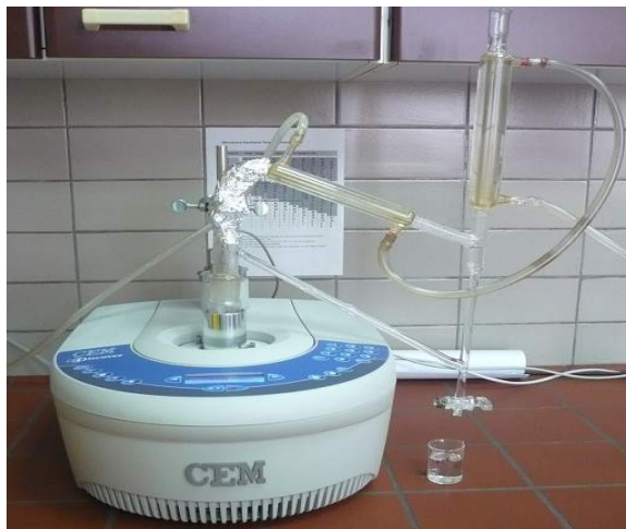
Slika 21. Modifikovana aparatura za mikrotalasnu hidrodestilaciju
