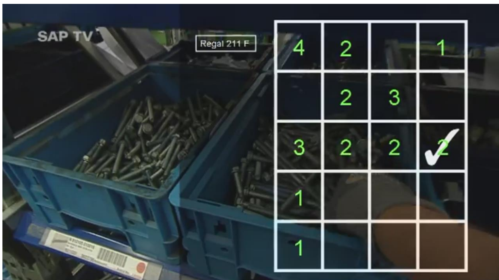
Slika 160.- SAP TV: SiWear - proširena stvarnost [web.81] (slika koja se vidi na displeju 3D naočara za nabavku prilikom trebovanja delova za montažu i oznaka čekiranja delova koji su uzeti iz magacina)
