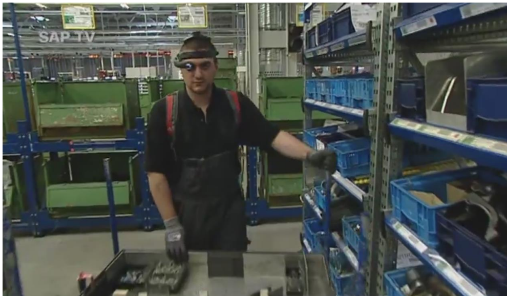
Slika 156.- SAP TV: SiWear - proširena stvarnost [web.81] (trebovanje potrebnih delova za montažu iz magacina pomoću 3D naočara)
