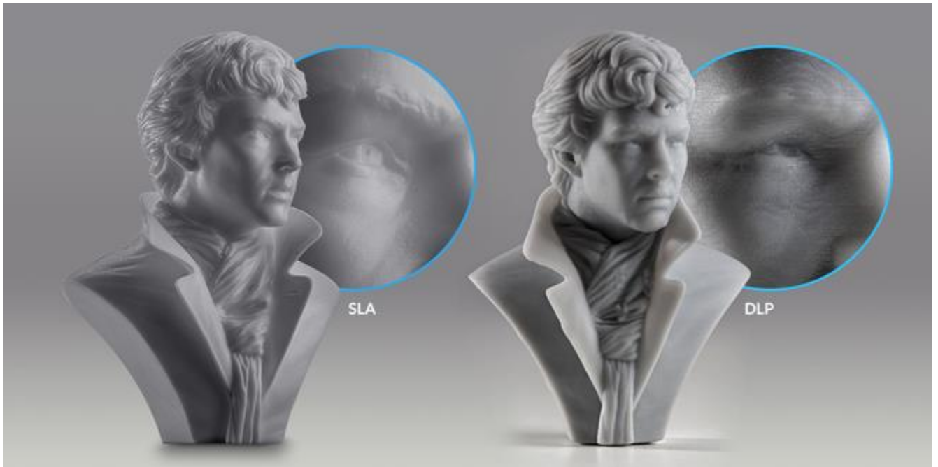
Slika 377.- Primer delova izradjenih SLA I DLP postupkom aditivne proizvodnje i njihova razlika [web.150]
