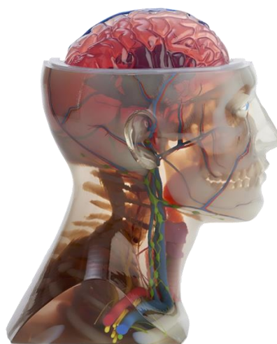
Slika 407.- Prikaz dela urađenog POLYJET tehnologijom [web.184]
