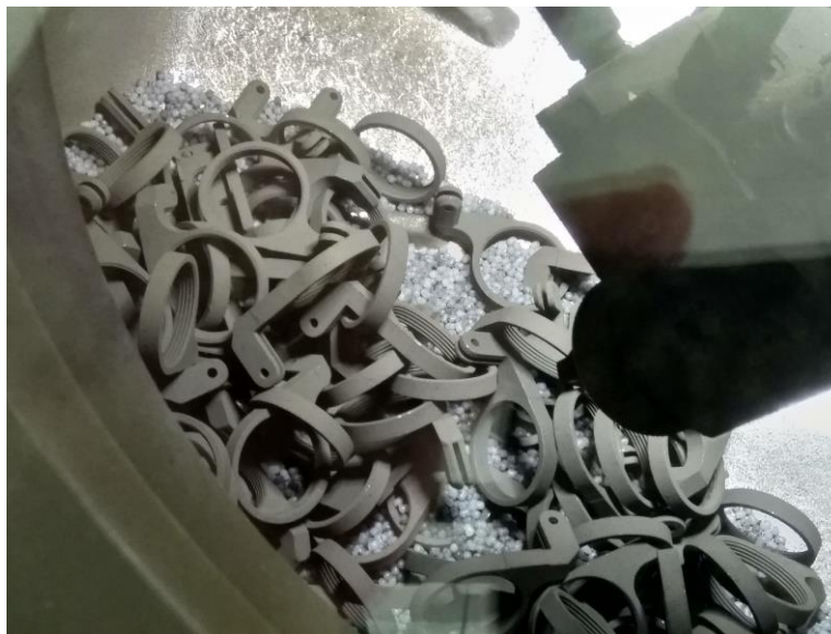
Slika 525.- Prikaz delova u toku nanošenja nanozaštite na bazi čestica WS2 u mašini Rotamat
