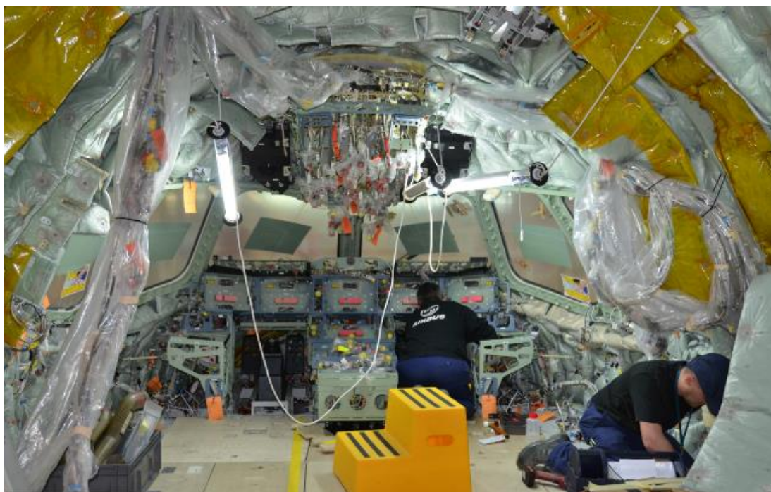
Slika 254.- Montaža kokpita aviona AIRBUS 350 [web.87]
