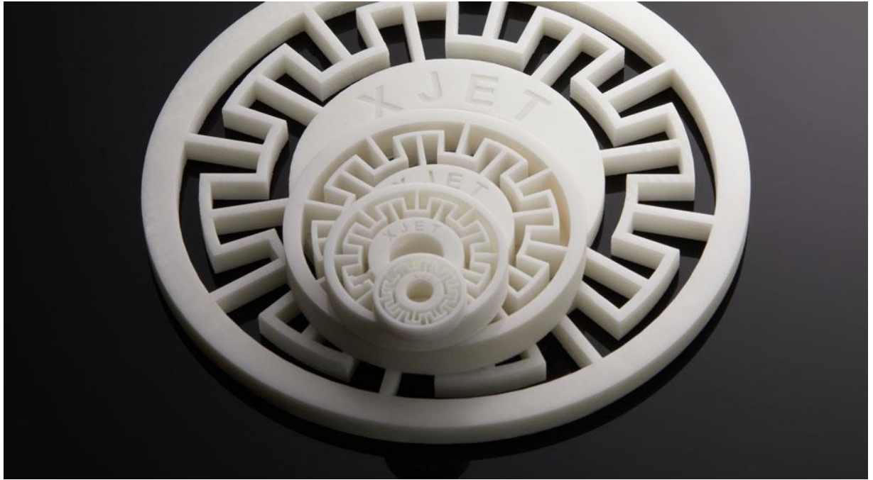
Slika 391.- Izgled keramičkih delova uradjenih postupkom NPJ (eng NANO PARTICLE JETTING ) [web.168]
