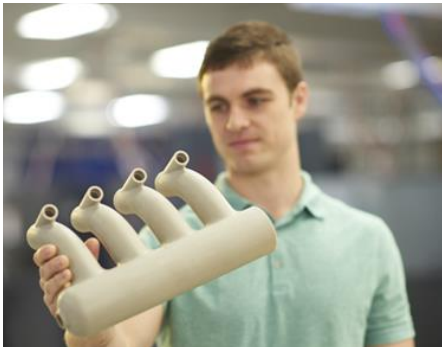
Slika 414.- Primer dela urađenog metodom SLS (eng. Selective Laser Sintering) [web.189]
