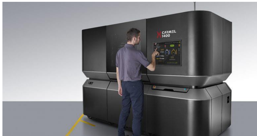
Slika 390.- NPJ 3D štampač (Model: Carmel 1400; Proizvođač: XJET) [web.167]
