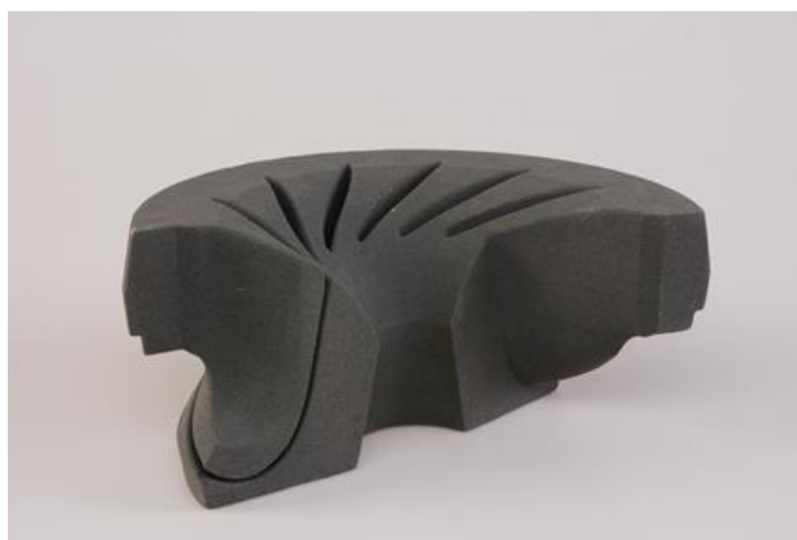
Slika 404.- Peščani kalup za livenje izradjen na 3D štampačima Voxeljet (postupak Power Binder Jetting) [web.180]
