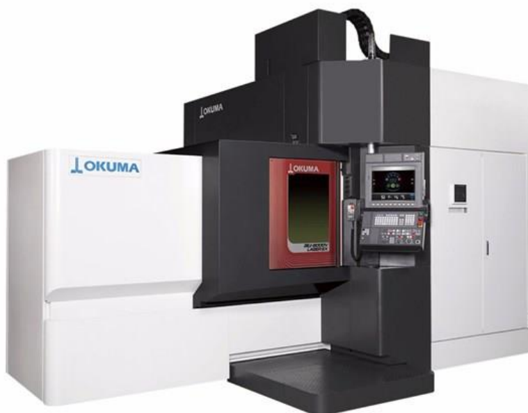
Slika 435.- Hibridna mašina (Okuma MU-8000 Laser Ex) sa laserskim odlaganjem metala (LMD) u kombinaciji sa 5-osnim CNC obradnim centrom [web.210]
