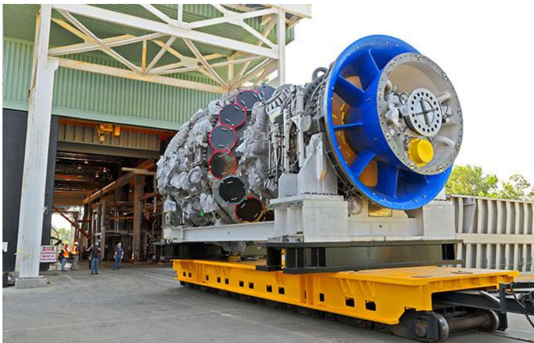
Slika 282.- Istovar gasne turbine 9HA u elektranu EDF Bouchain [web.92]
