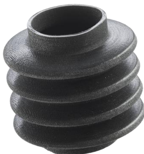
Slika 408.- Prikaz dela urađenog POLYJET tehnologijom uz primenu materijala AGILUS 30 [web.184]
