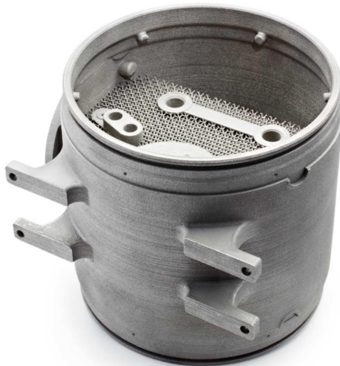
Slika 421.- Izgled dela izradjenog metodom selektivnog topljenja elektronskim snopom (EBM) [web.196]
