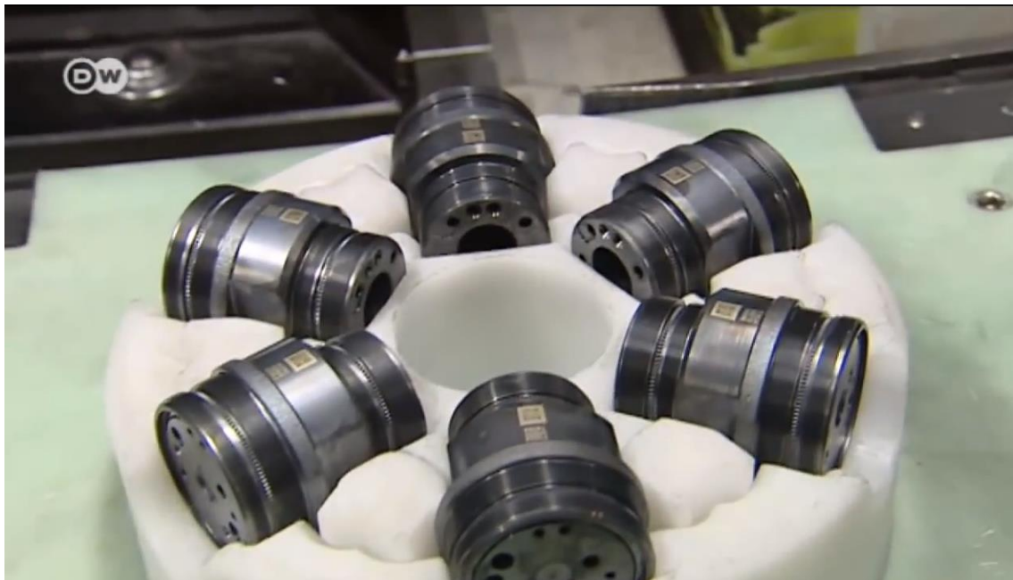
Slika 136.- Izgled izgraviranog bar-koda [web.70]
