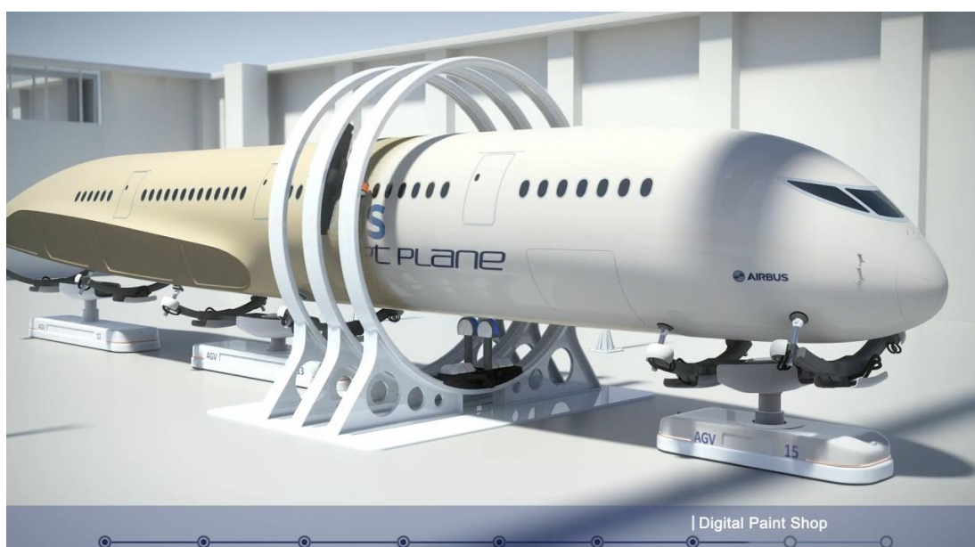
Slika 247.- Fabrika budućnosti AIRBUS (robotizovano digitalno inject farbanje aviona bez zaštitne komore) [web.85]
