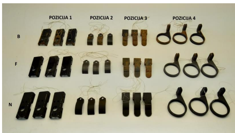
Slika 526.- Uporedni prikaz čeličnih delova nakon testiranja u slanoj komori tretiranih brunirom, fosfatnim slojem i nano zaštitom (na bazi nano čestica WS2)
