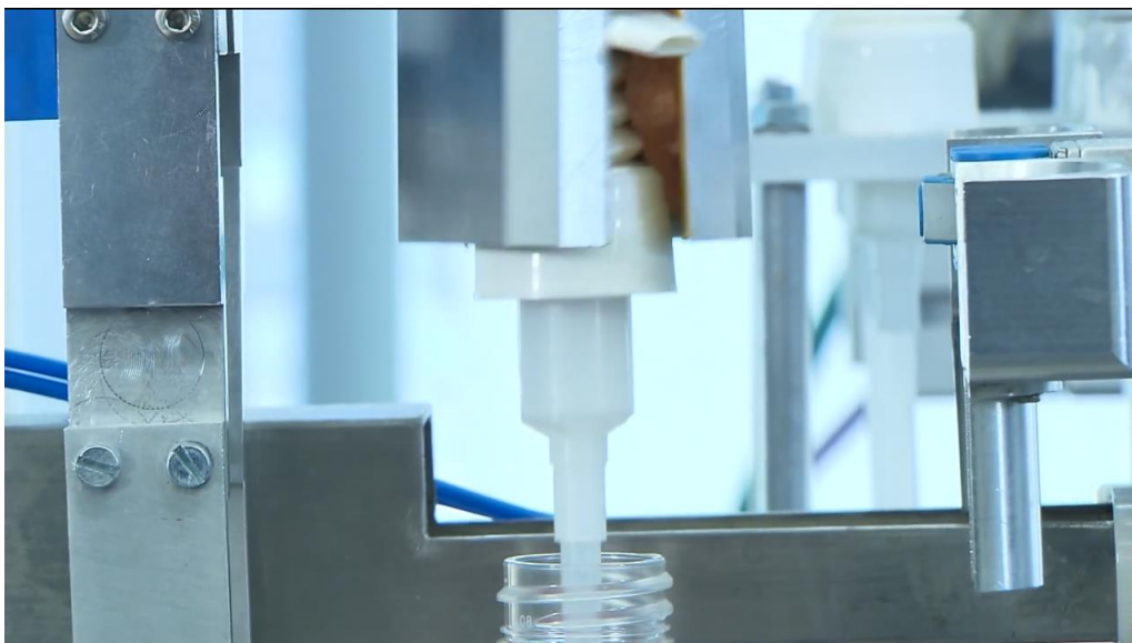
Slika 100.- Zatvaranje poklopca flaše sa čipom [web.54]
