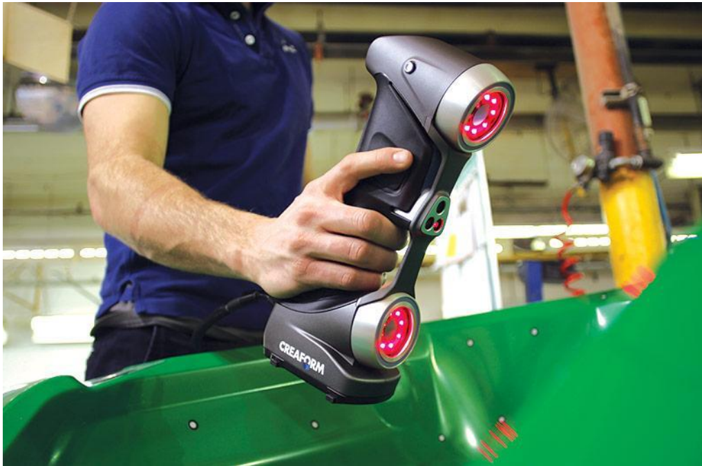
Slika 364.- Primer ručnog 3D skenera kompanije CREAFORM [web.139]
