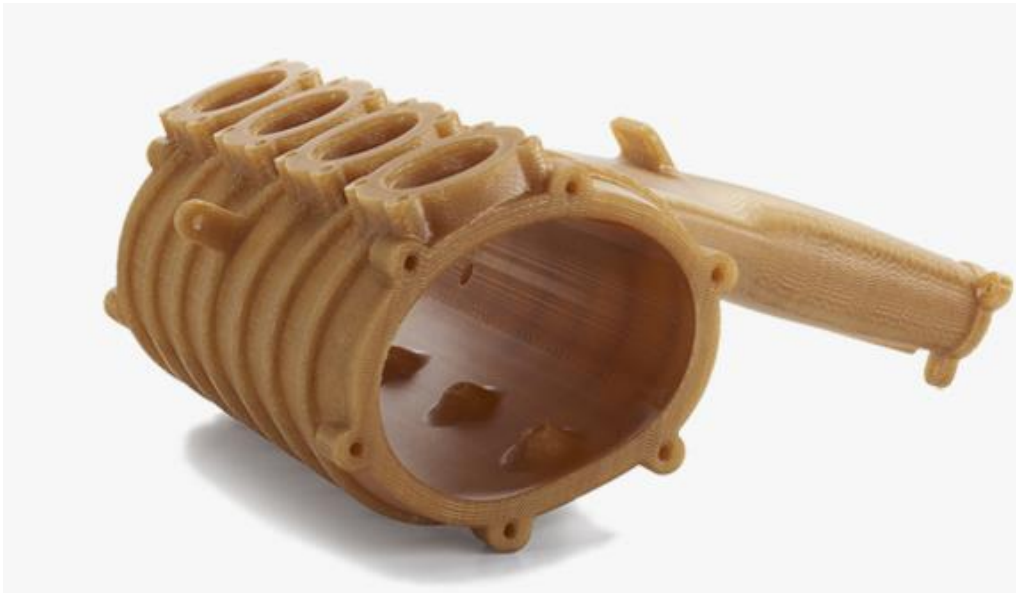
Slika 384.- Izgled 3D dela uradjenog FDM postupkom aditivne proizvodnje [web.162]
