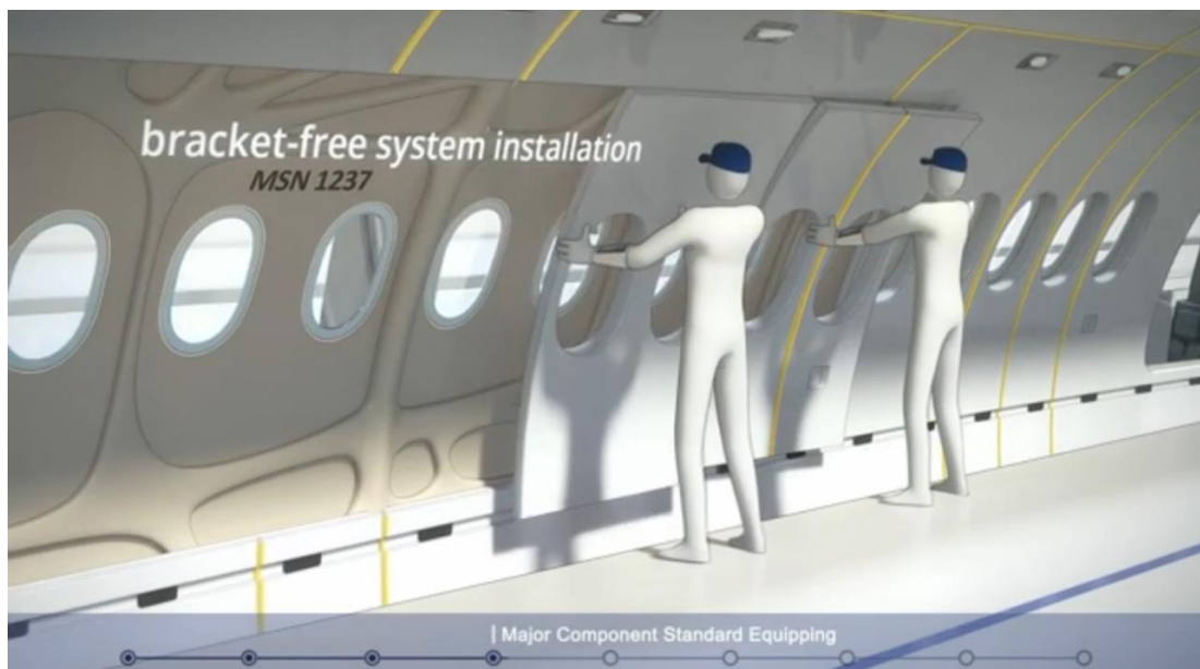
Slika 209.- Fabrika budućnosti AIRBUS (sektor sklapanja glavnih standardnih komponenti - sistem instalacije slobodnih nosača) [web.85]
