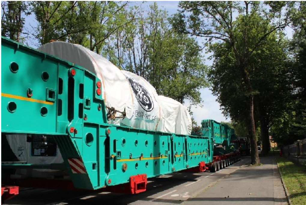
Slika 280.- Dopremanje gasne turbine 9HA vozom u elektranu EDF Bouchain [web.92]
