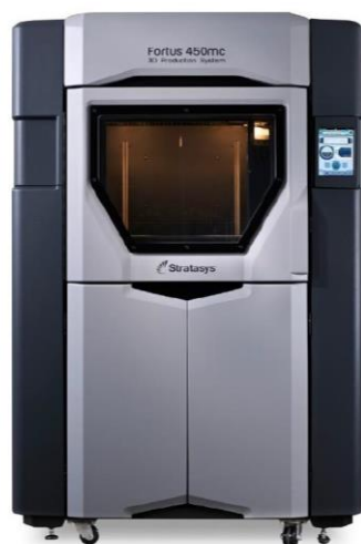
Slika 383.- 3D štampač STRATASYS – FORTUS 450mc za FDM postupak aditivne proizvodnje [web.161]
