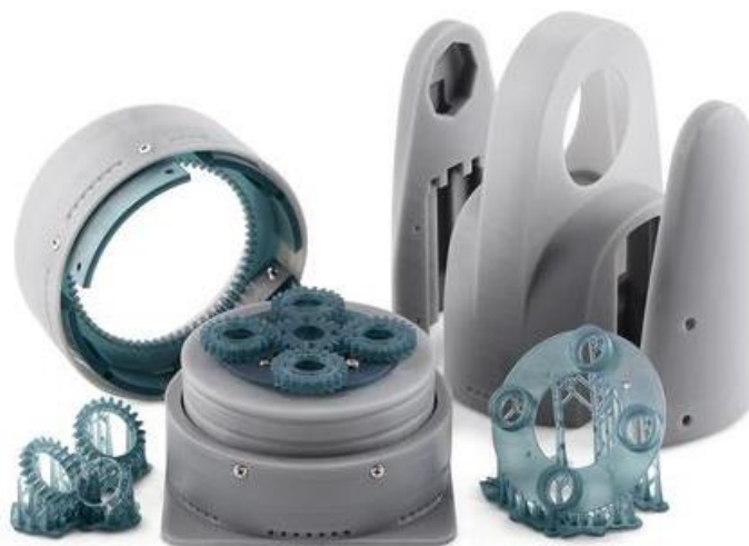
Slika 372.- Primer delova urađenih postupkom SLA tehnologije (eng. STEREOLITOGRAPHY) [web.149]
