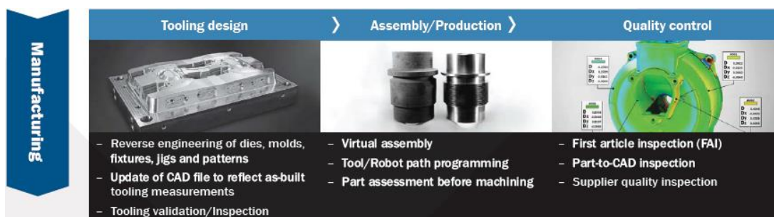
Slika 362.- Upotreba 3D skenera u fazi proizvodnje PLM ciklusa [web.138]
