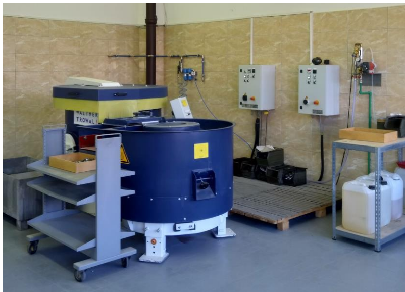
Slika 523.- Vibromašina za odmašćivanje i pripremu delova pre površinske zaštite proizvođača Walther Trowal u kompaniji Teleoptik-Žiroskopi
