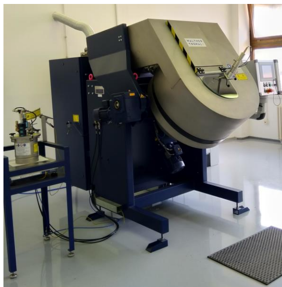
Slika 524.- Mašina za nanošenje nano zaštite "Rotamat" proizvođača Walther Trowal, u kompaniji Teleoptik-Žiroskopi
