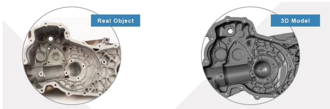
Slika 358.- Slika realnog objekta i proizvoda koji je nastao nakon obrade 3D modela dobijenog 3D skenerom [web.138]
