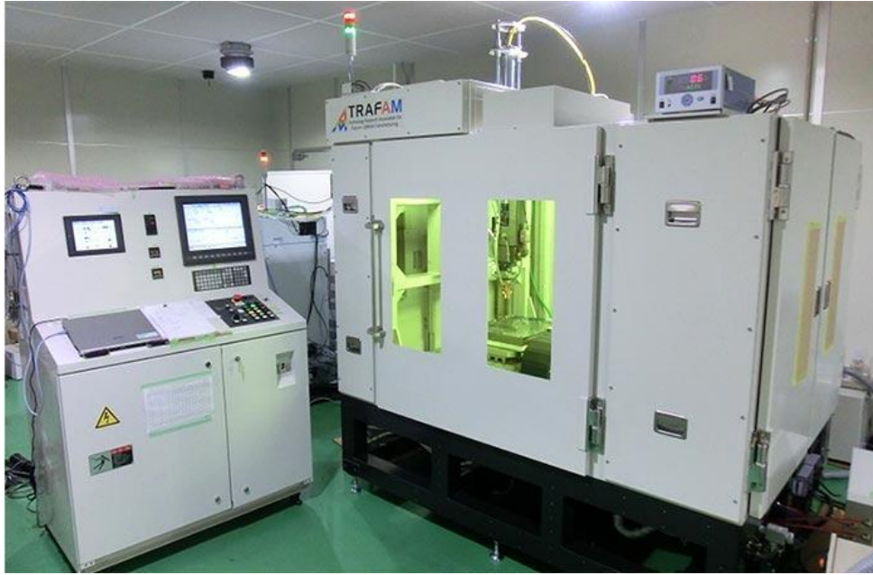
Slika 425.- Izgled mašine za 3D postopak aditivne proizvodnje lasersko taloženje metala (LMD) [web.201]
