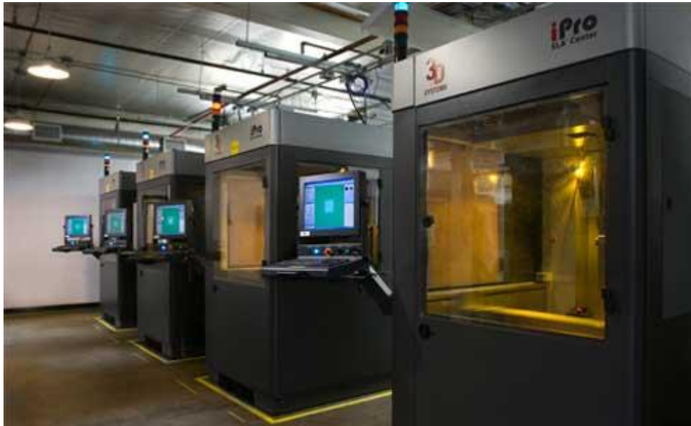
Slika 371.- Primer štampača za postupak aditivne proizvodnje – stereolitografija [web.148]
