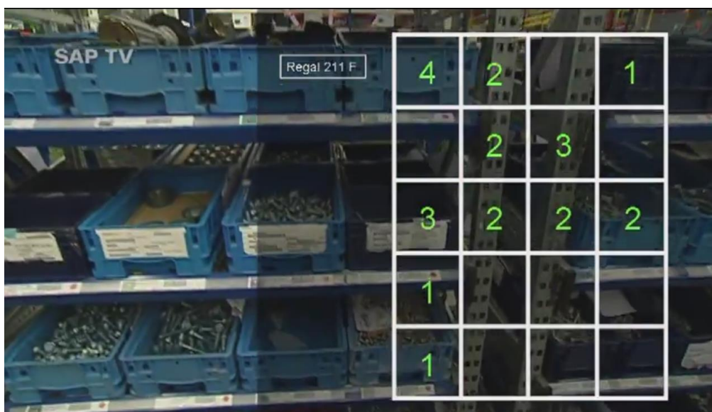
Slika 159.- SAP TV: SiWear - proširena stvarnost [web.81] (izgled displeja 3D naočara za trebovanje materijala iz magacina za montažu)
