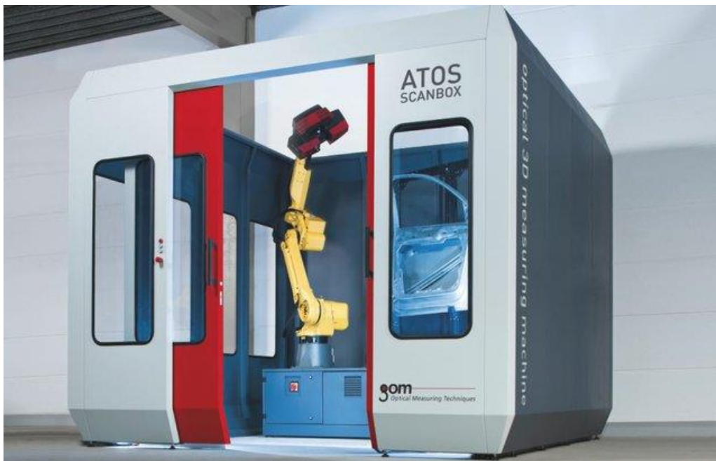
Slika 365.- Primer automatskog 3D skenera ATOS za metrološka merenja [web.140]
