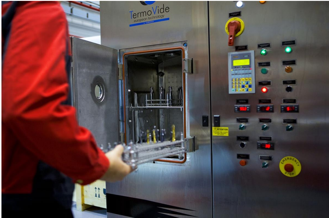
Slika 449.- Termička obrada (stabilizacija) reznog alata [web.217]
