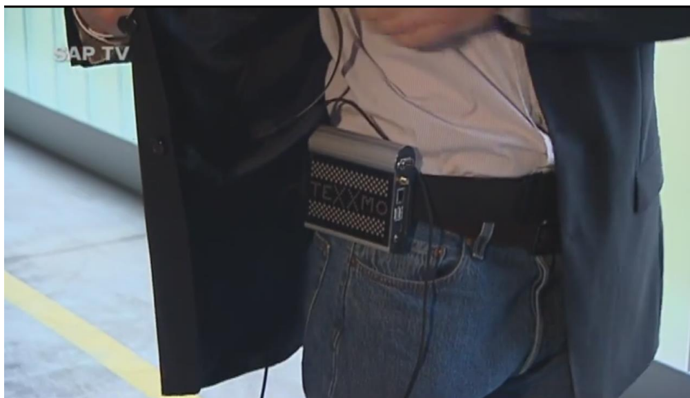
Slika 155.- SAP TV: SiWear - proširena stvarnost [web.81] (Savremenija manja i kompaktnija verzija kompjutera i pratećih baterija za napajanje 3D naočara, za trebovanje potrebnih delova iz magacina za montažu)
