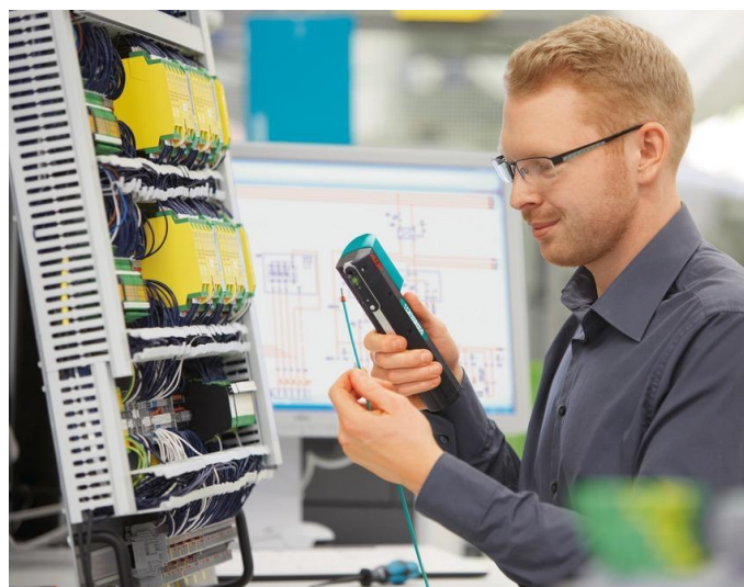
Slika 53.- Ručno nabiranje, sprava za mobilno guljenje i presovanje [web.43]
