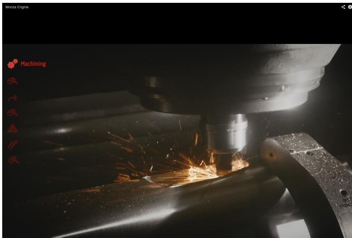
Slika 461.- Postupak mašinske obrade glodanjem na CNC obradnom centru [web.137]
