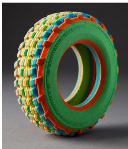
Slika 433.- Primer dela uradjenog metodom 3d štampe Sheet Lamination (LOM) [web.208]
