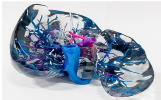
Slika 387.- Deo izradjen metodom Material Jetting (MJ) aditivne proizvodnje [web.166]
