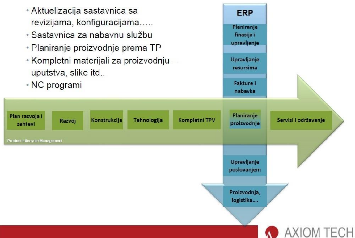
Slika 332.- Interakcija ERP-PLM u proizvodnom procesu [4]
