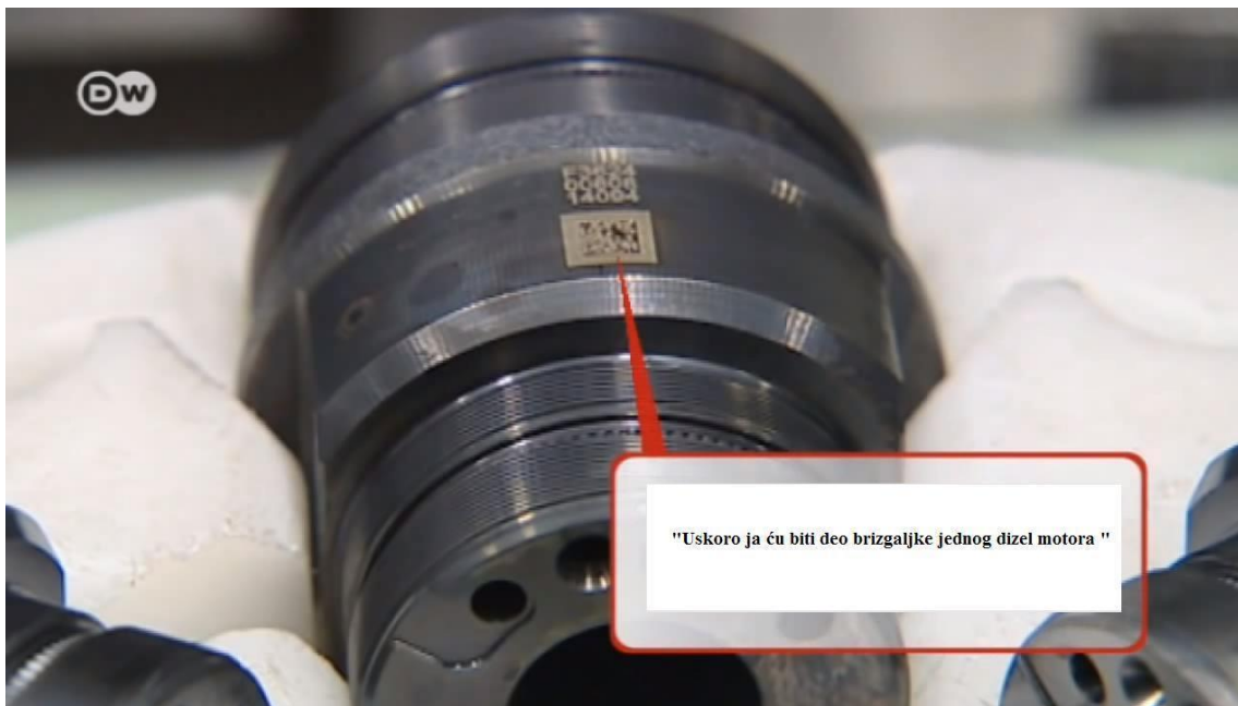
Slika 138.- Značenje izgraviranog bar-koda [web.70]
