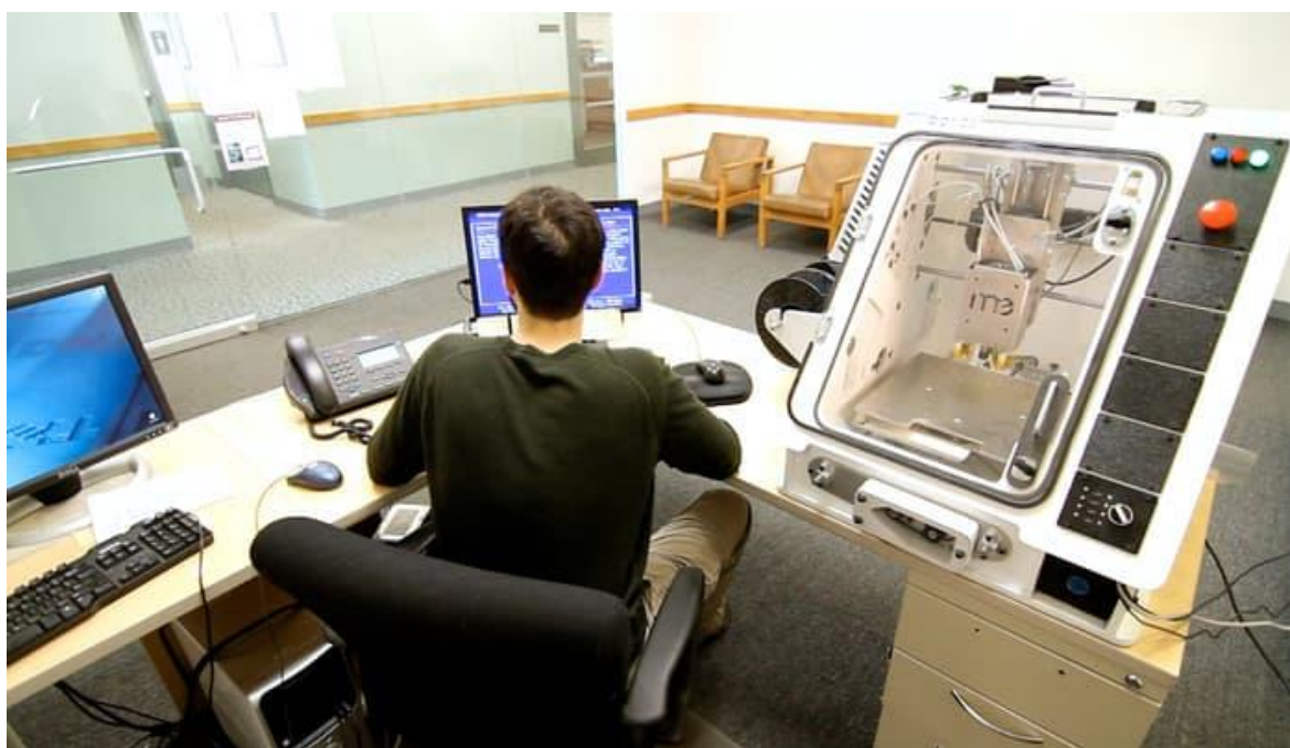
Slika 508.- Primer upotrebe mikro fabrike korišćenjem CNC mikro obradnog centra kompanije Mebotics [web.227]
