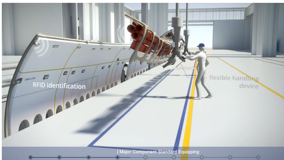
Slika 219.- Fabrika budućnosti AIRBUS (istovar delova pomoću fleksibilne sprave za rukovanje posredstvom RFID identifikacije) [web.85]
