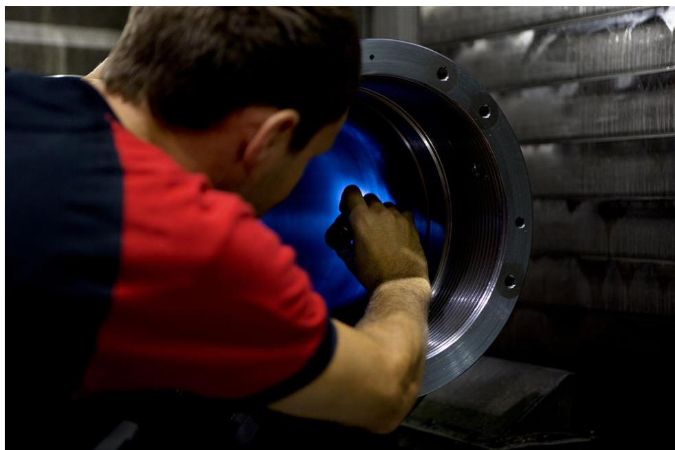
Slika 484.- Prikaz ispitivanja dela na mikro pukotine metodom bez razaranja materijala [web.137]
