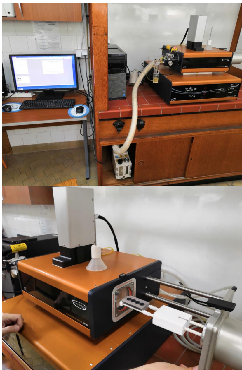
Slika 4.11. Discovery Xenon Flash DXF-500 (TA Instruments) za merenje termičke difuzivnosti
