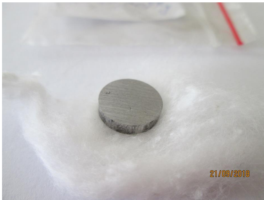
Slika 4.14. Presovani uzorak eutektičke legure za ispitivanje toplotne provodljivosti
