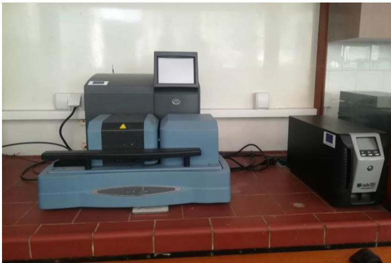
Slika 4.5. Uređaj SDT Q600 na kojem je izvršena DSC analiza legura na bazi bizmuta
