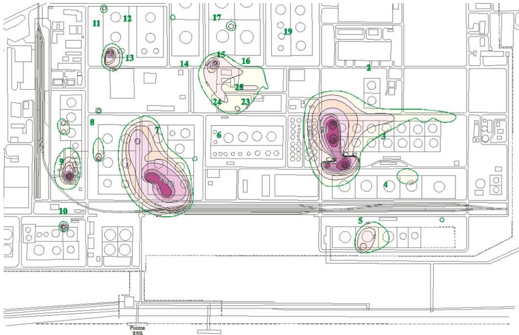
Slika 36. Sadržaj volatilnih ugljovodonika u gasnoj fazi na dubini od 1,5 m (Anon, 2001)
