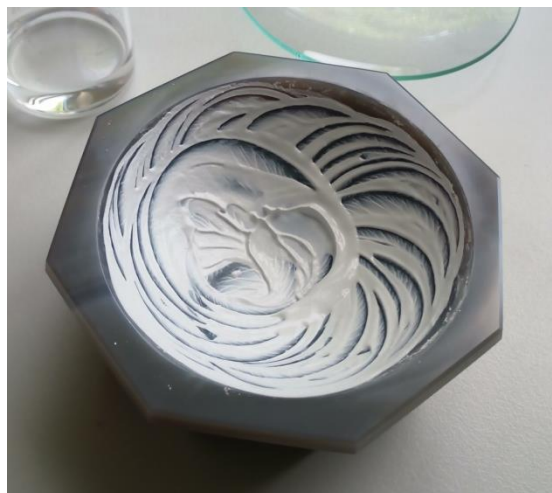
Slika 31. Fotografija ahatnog avana u toku mešanja i usitnjavanja polaznih komponenti
