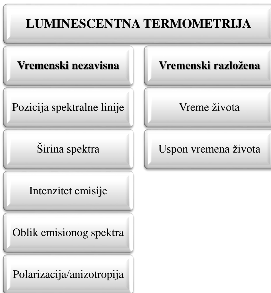
Slika 17. Različiti načini očitavanja temperature na osnovu luminescencije
