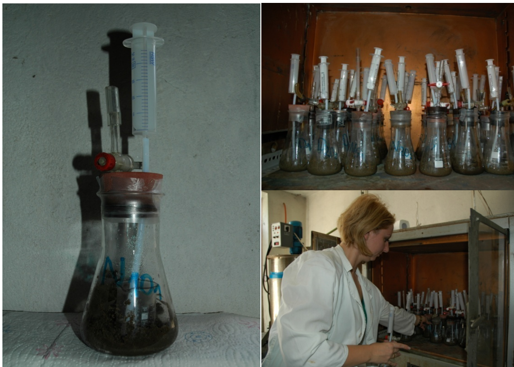
Slika 3.8. Ispitivanje biodegradacije – biometri
