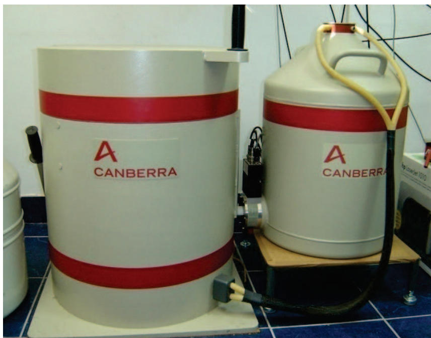
Slika 3.6. HPGe detektor relativne efikasnosti 100% sa karbonskim prozorom
