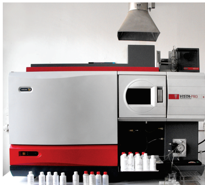
Slika 3.5. Uređaj za atomsku emisionu spektroskopiju sa induktivno kuplovanom plazmom (Varian, Vista-Pro Axial)
