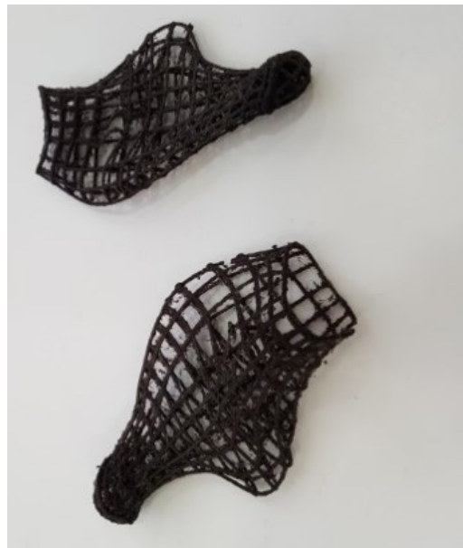
Slika 7-35 Skafold nakon uklanjanja noseće strukture od PVA materijala rastvaranjem u vodi
