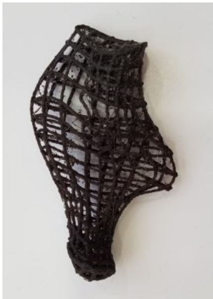
Slika 7-35 Skafold nakon uklanjanja noseće strukture od PVA materijala rastvaranjem u vodi
