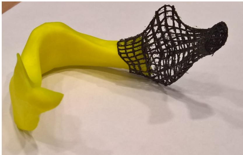
Slika 7-38 Nedograđeni, realno-asimetrični model mandibule u sklopu sa personalizovanim skafoldom za njenu regeneraciju
