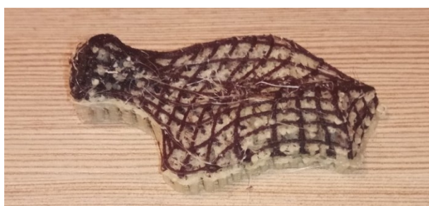
Slika 7-34 Skafold nakon skidanja spoljašnjeg omotača tzv. Ooze Shield
