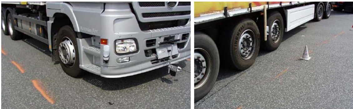
Slika 2.37 Postavljanje rezervoara sa vodom na mestima najisturenijih tačaka na vozilu tokom izvođenja testnih vožnji (izvor: Glabsch i ost. 2012)
