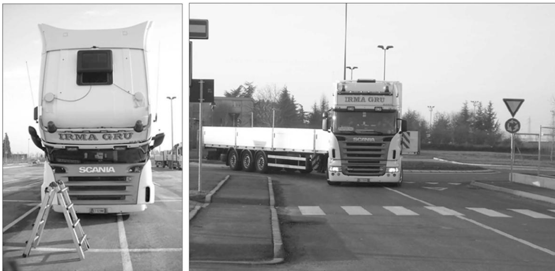
Slika 2.46 Položaj GPS rovera na kabini tegljača (levo), i izlazak šlepera iz kružnog toka posle skretanja pod uglom od 180° (desno) (izvor: Pecchini & Giuliani 2013)
