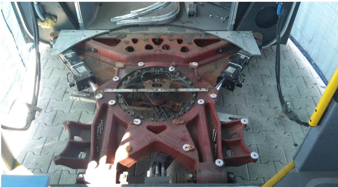
Slika 3.28 Konstrukcija zgloba na šasiji zglobnog autobusa Solaris Urbino 18
