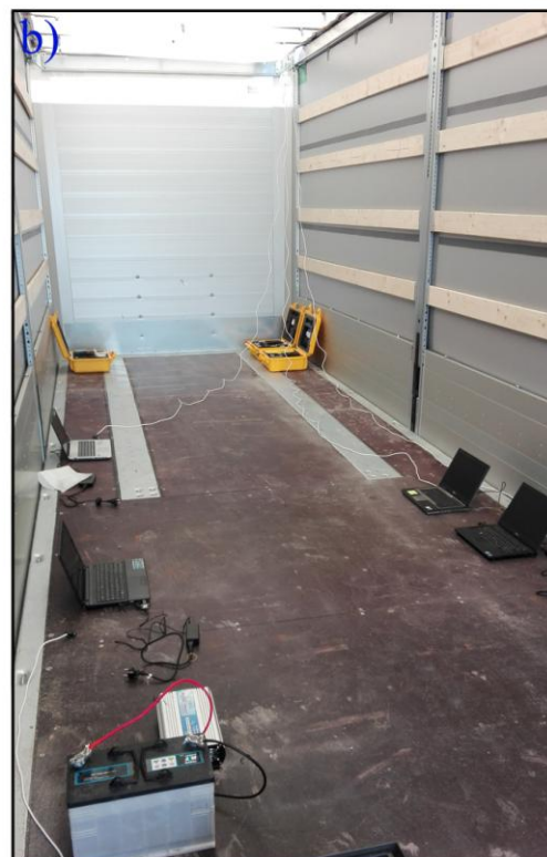
Slika 3.6 Montiranje Trimble rovera na prvo testno vozilo - šleper: a) postavljanje GPS rovera na vrh bočne krute stranice Schmitz poluprikolice; b) povezivanje 4 instalirana GPS rovera sa 4 prenosna računara smeštena na podu poluprikolice
