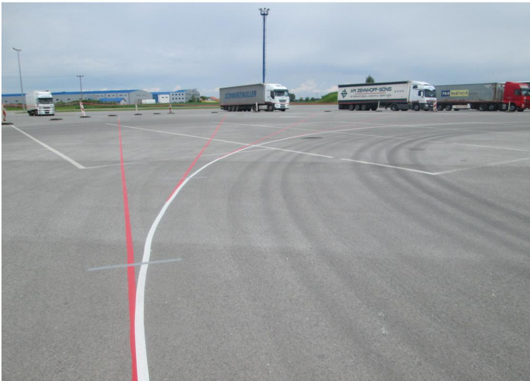
Slika 3.4 Označavanje vodećih putanja pomoću specijalne crvene ili bele polietilenske trake kojom su spajane tačke prethodno obeležene na površini kolovoza poligona
