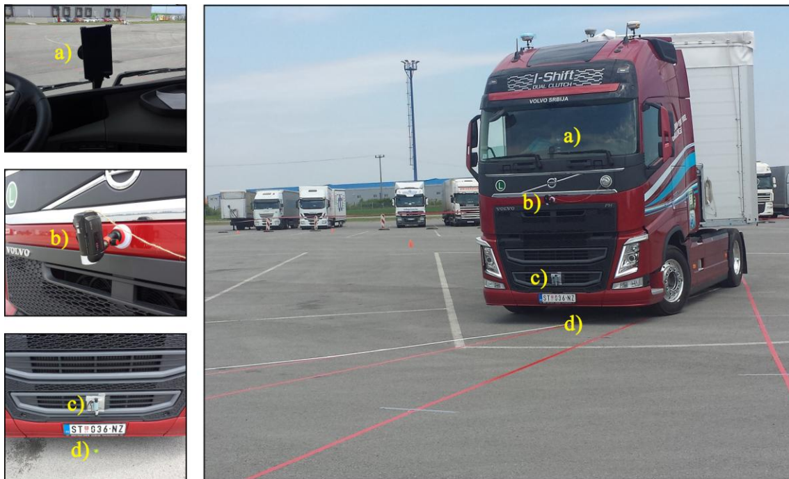
Slika 3.9 Volvo FH 500 tegljač skreće pod uglom od 120^\circ na testnom poligonu:
