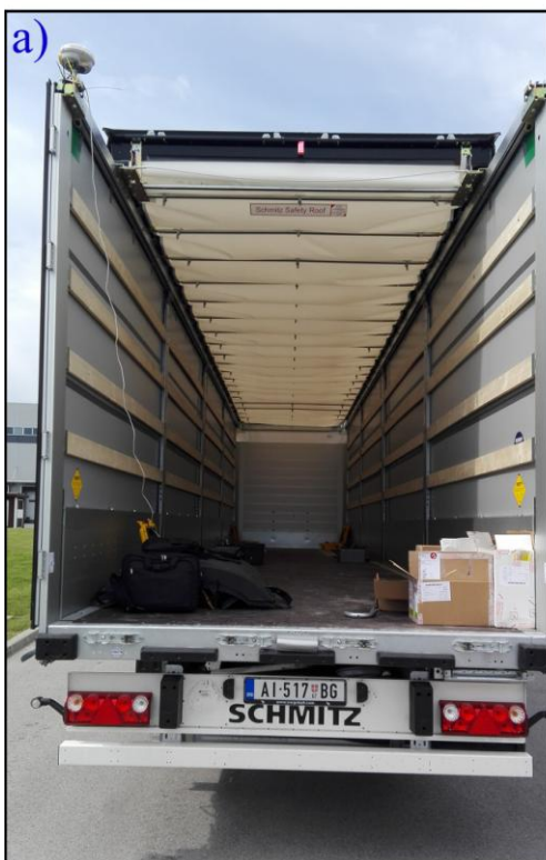
Slika 3.6 Montiranje Trimble rovera na prvo testno vozilo - šleper: a) postavljanje GPS rovera na vrh bočne krute stranice Schmitz poluprikolice; b) povezivanje 4 instalirana GPS rovera sa 4 prenosna računara smeštena na podu poluprikolice
