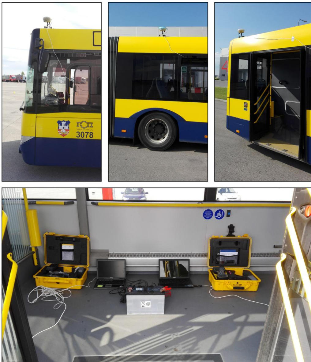
Slika 3.7 Postavljanje 3 GPS rovera na krov Solaris-ovog zglobnog autobusa i njihovo povezivanje sa prenosnim računarima smeštenim na podu autobusa
