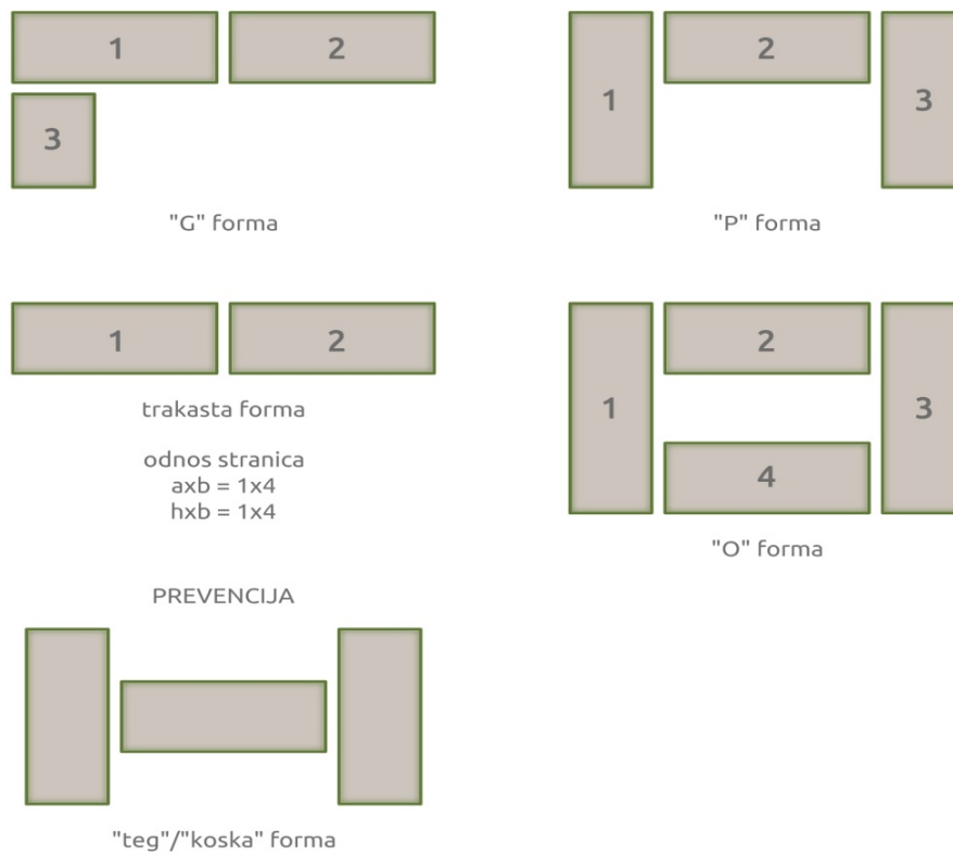
Slika 4.10. Dilatacije objekta uslovljene formom osnovne objekta
