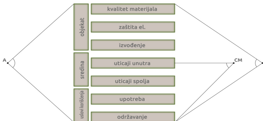
Slika 4.14 Perspektiva arhitekta upravljanje objektom prema standardu ISO15686-4
