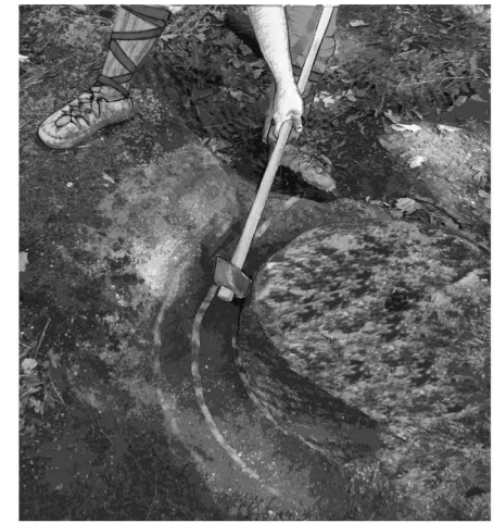
Slika 3.22. Rekonstrukcija procesa izrade žrvnja u kamenolomu: ucrtavanje kontura budućeg žrvnja (gore); usecanje kanala (dole) (prema: Jaccotey 2011: 302, Fig. 17,18)
