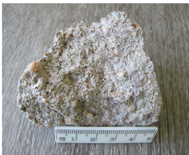
Slika 5.31. Makroskopski izgled žrvnja sa Gamzigrada (kat.br.113) izrađenog od kvarc-arenitskog konglomeratičnog pešćara; vidljivi su dobro zaobljeni valutci kvarcита i sitni pečati mrke boje koji vode poreklo od hidroksida gvožđa.
