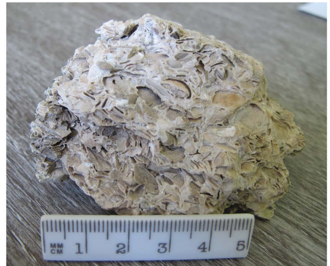
Slika 5.33. Makroskopski izgled žrvnja sa Gamzigrada (kat.br.254) izrađenog od organogenog (školjčanog) krečnjaka; zapažaju se ovalne forme ljuštura školjaka i poroznost stenske mase.
