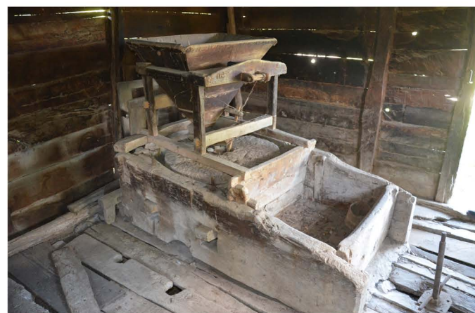
Slika 3.77. Tradicionalna vodenica porodice Borikić u selu Nemenikuće kod Sopota, podno Kosmaja (XX vek): objekat (a), korišćeno vodenično kamenje (b), mlin sa okolišem i košem (c), horizontalni vodenični točak (d) (foto: M. Jovičić)
