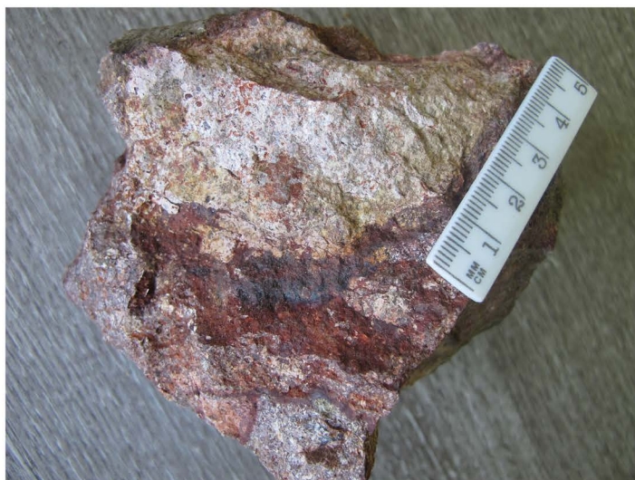
Slika 5.29. Makroskopski izgled žrvnja sa Gamzigrada (kat.br.176) izrađenog od crvenog tufa; nehomogen je po boji, sa elementima vulkanoklastične strukture.
