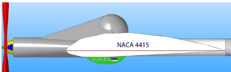
Slika 100 - Prikaz preseka krila letelice ALPEMA sa vidljivim aeroprofilom
