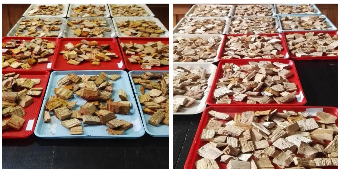
Слика 5.5 Изглед дрвне сечке узорковане а) у бункеру где се складишти б) након сушења, непосредно пре уласка у гасификаторе
