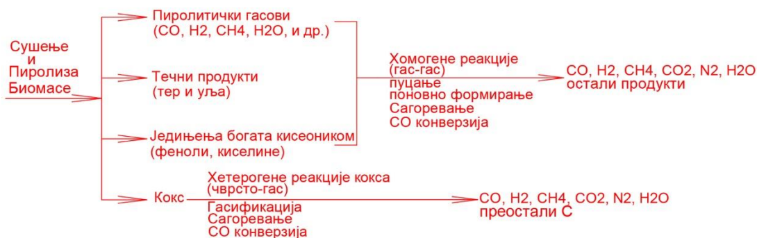
Слика 2.1 Шематски упростио приказ процеса гасификације биомасе [21, 22]
