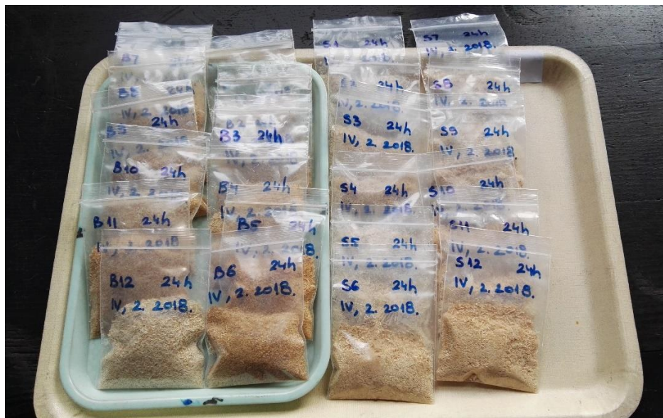
Слика 5.6 Дрвна сечка припремљена за техничку и елементарну анализу
