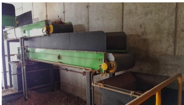
Слика 5.4 Дрвна сечка, пут од другог бункера до уласка у гасификатор
