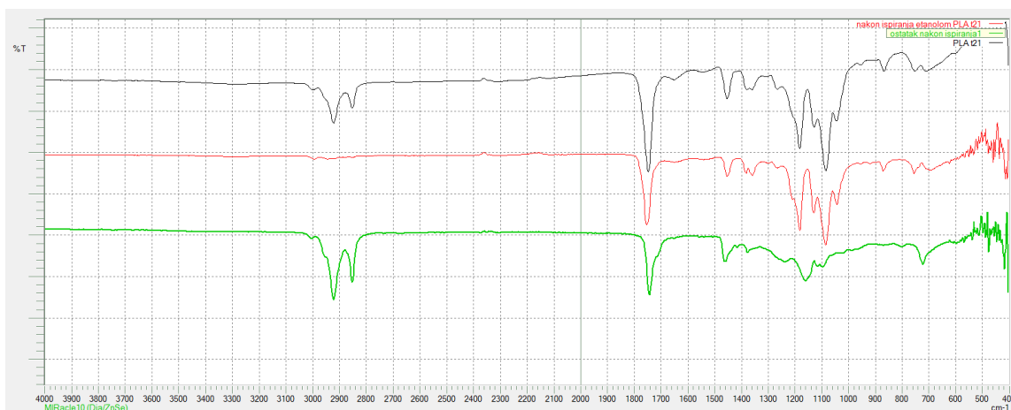
Slika 43. Poređenje IC spektara materijala na osnovu PLA pre i nakon ispiranja i IC spektar ekstrahovane supstance
