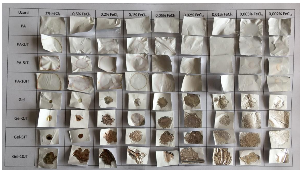
Slika 61. Ispitivanje granice detekcije senzora na osnovu PA i želatina a) do koncentracije \text{Fe}^{3+} jona od 0,02%, b) koncentracija \text{Fe}^{3+} jona od 0,01% i c) sve ispitivane koncentracije
