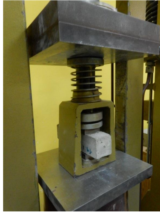
Slika 71 - Ispitivanje čvrstoće maltera pri pritisku
