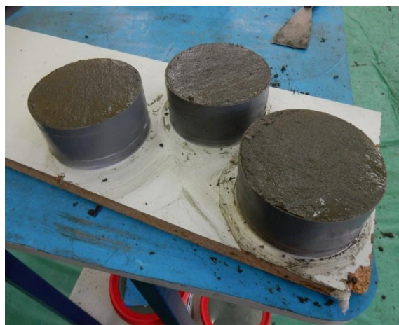
Slika 68 - Beton ugrađen u kalupe oblika cilindra
