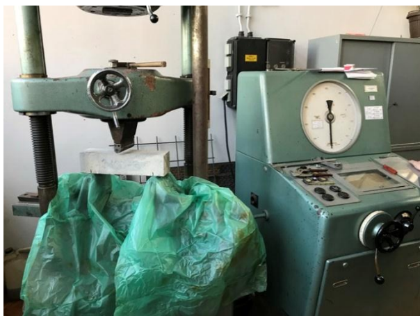
Slika 83 - Izgled opreme za ispitivanje čvrstoće betona na savijanje
