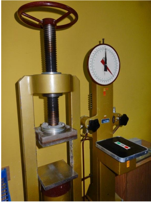
Slika 71 - Ispitivanje čvrstoće maltera pri pritisku
