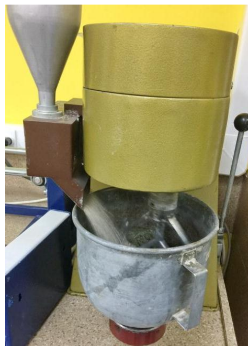
Slika 56 - Spravljanje mješavine za ispitivanje indeksa aktivnosti biopepela u laboratorijskoj mješalici
