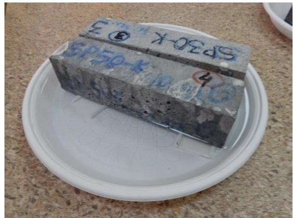
Slika 72 - Ispitivanje kapilarnog upijanja vode pritisku
