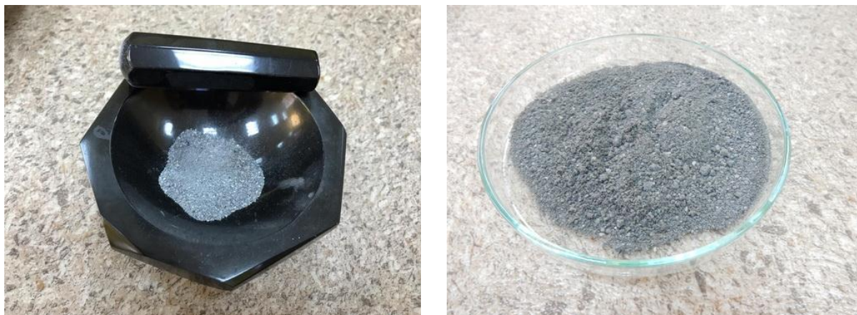
Slika 85 - Avan sa tučkom i prah dobijen za ispitivanje mikrostrukture materijala
