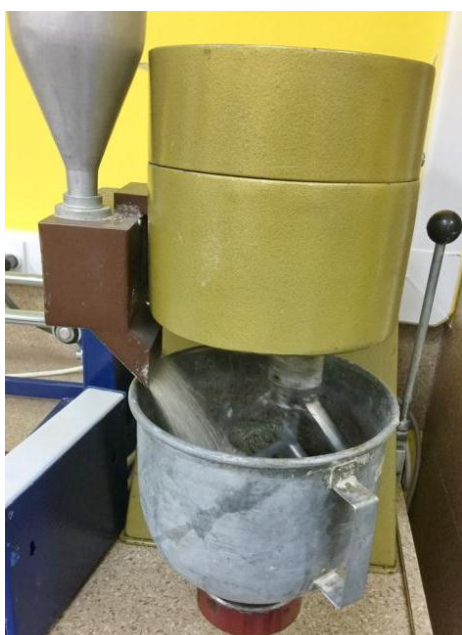
Slika 62 - Spravljanje maltera u laboratorijskom mikseru
