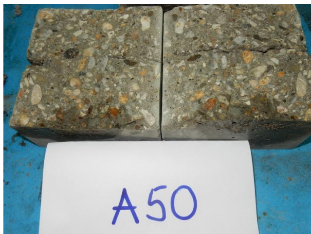
Slika 79 - Mjerenje dubine prodora vode, nakon cijepanja uzorka
