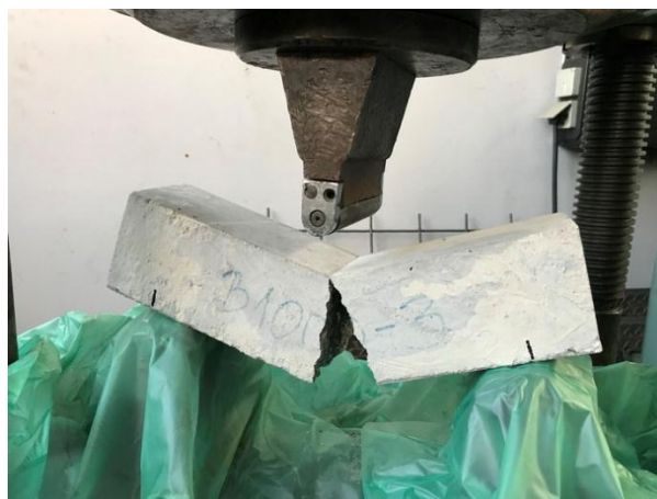
Slika 84 - Izgled uzorka nakon ispitivanja čvrstoće betona na savijanje
