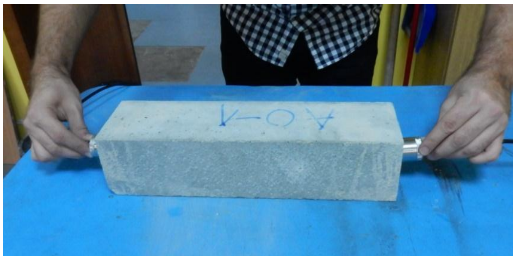
Slika 76 - Ispitivanje brzine prolaza ultrazvuka
