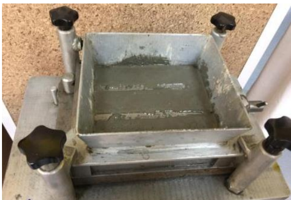
Slika 64 - Kompaktiranje maltera na potresnom stolu
