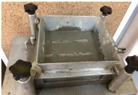
Slika 57 - Kompaktiranje uzotaka za ispitivanje indeksa aktivnosti biopepela na potresnom stolu
