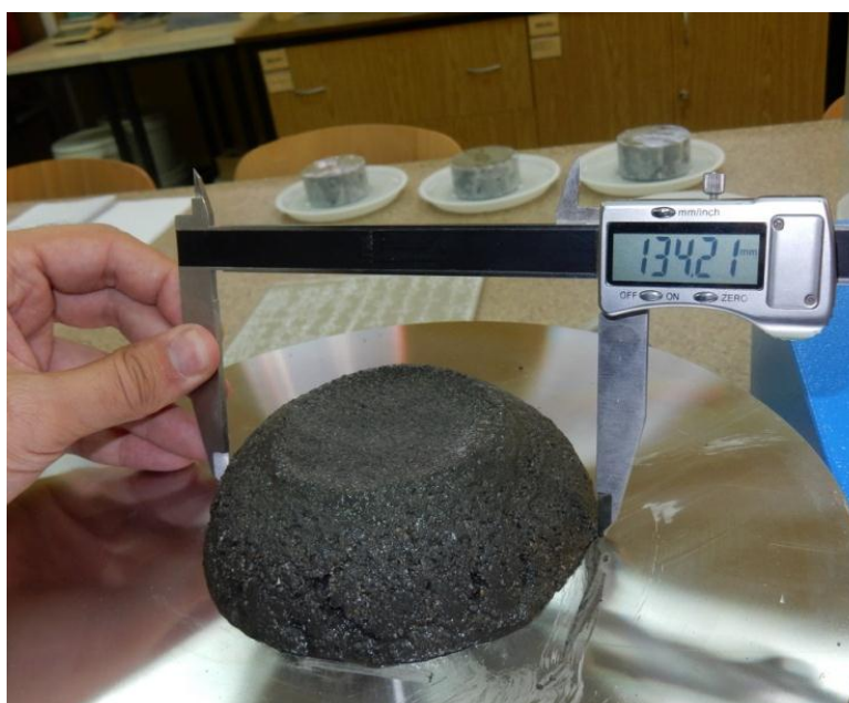
Slika 63 – Određivanje konzistencije maltera na potresnom stolu
