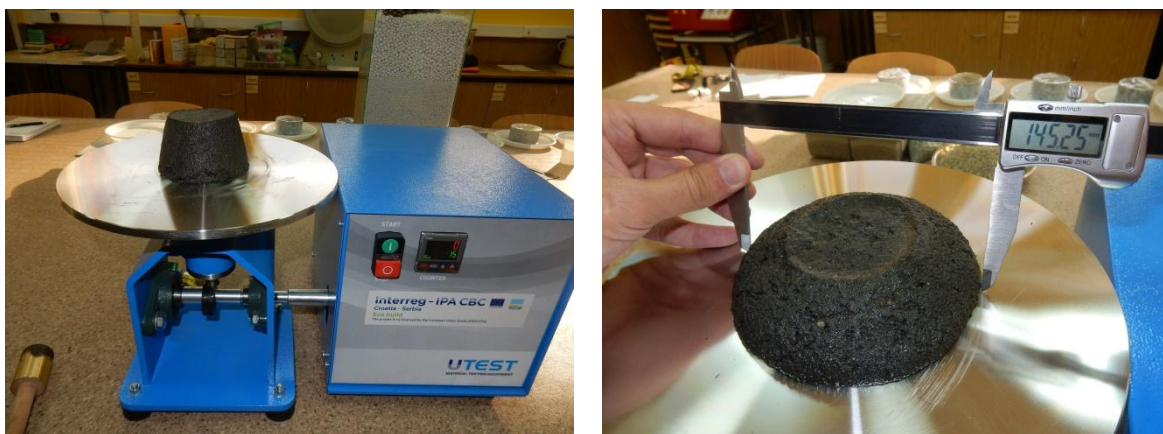
Slika 70 - Mjerenje konzistencije maltera na potresnom stolu
