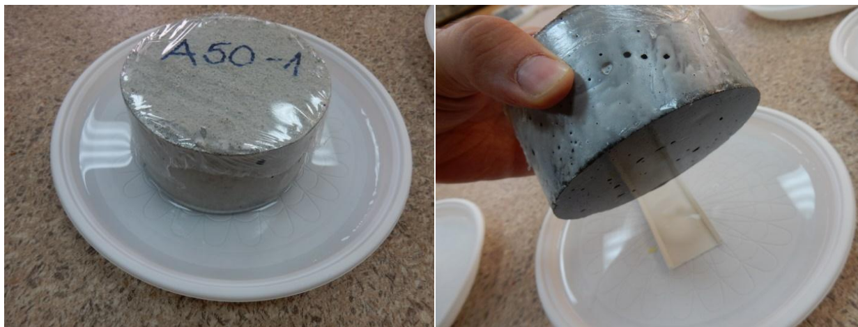
Slika 77 - Ispitivanje upijanja vode pod pritiskom
