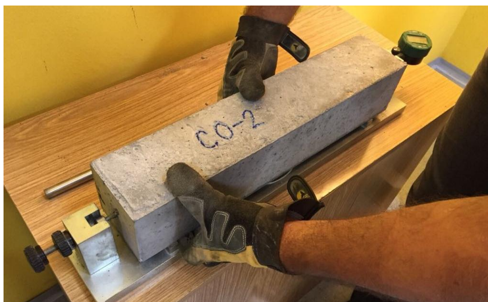
Slika 80 - Ispitivanje skupljanja pri sušenju betona
