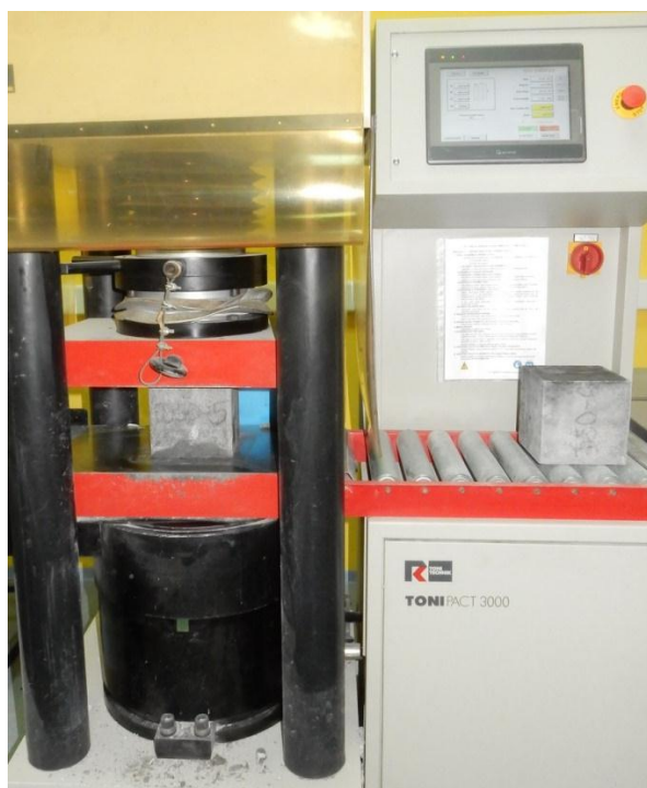
Slika 74 - Određivanje čvrstoće pri pritisku
