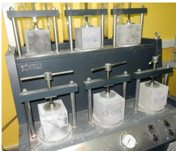
Slika 78 - Ispitivanje upijanja vode pod pritiskom
