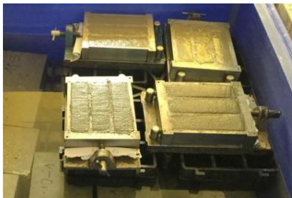
Slika 58 - Njega uzoraka za ispitivanje indeksa aktivnosti biopepela
