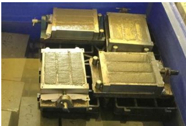
Slika 65 – Odležavanje uzoraka u kalupima u vlažnoj komori
