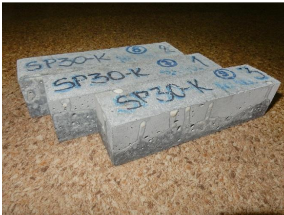
Slika 72 - Ispitivanje kapilarnog upijanja vode pritisku
