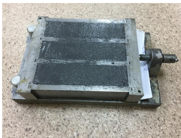
Slika 53 - Standardne malterske prizmice za ispitivanje pucolanske aktivnosti biopepela
