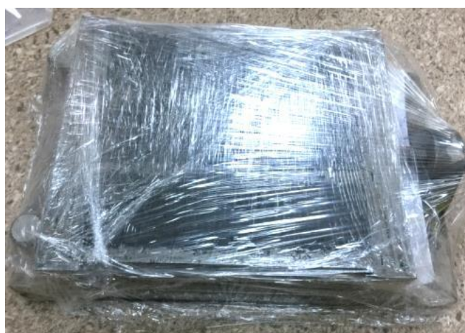
Slika 54 - Hermetički zatvoreni i izolovani uzorci za ispitivanje pucolanske aktivnosti biopepela
