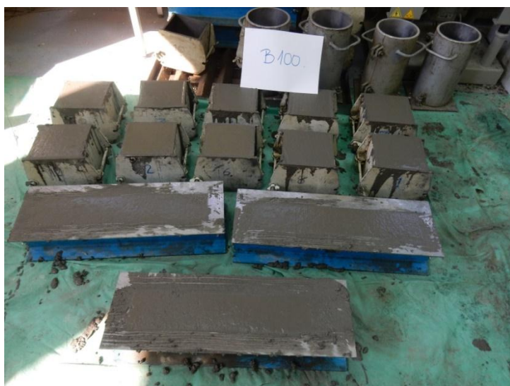
Slika 69 - Beton ugrađen u kalupe oblika kocke i cilindra
