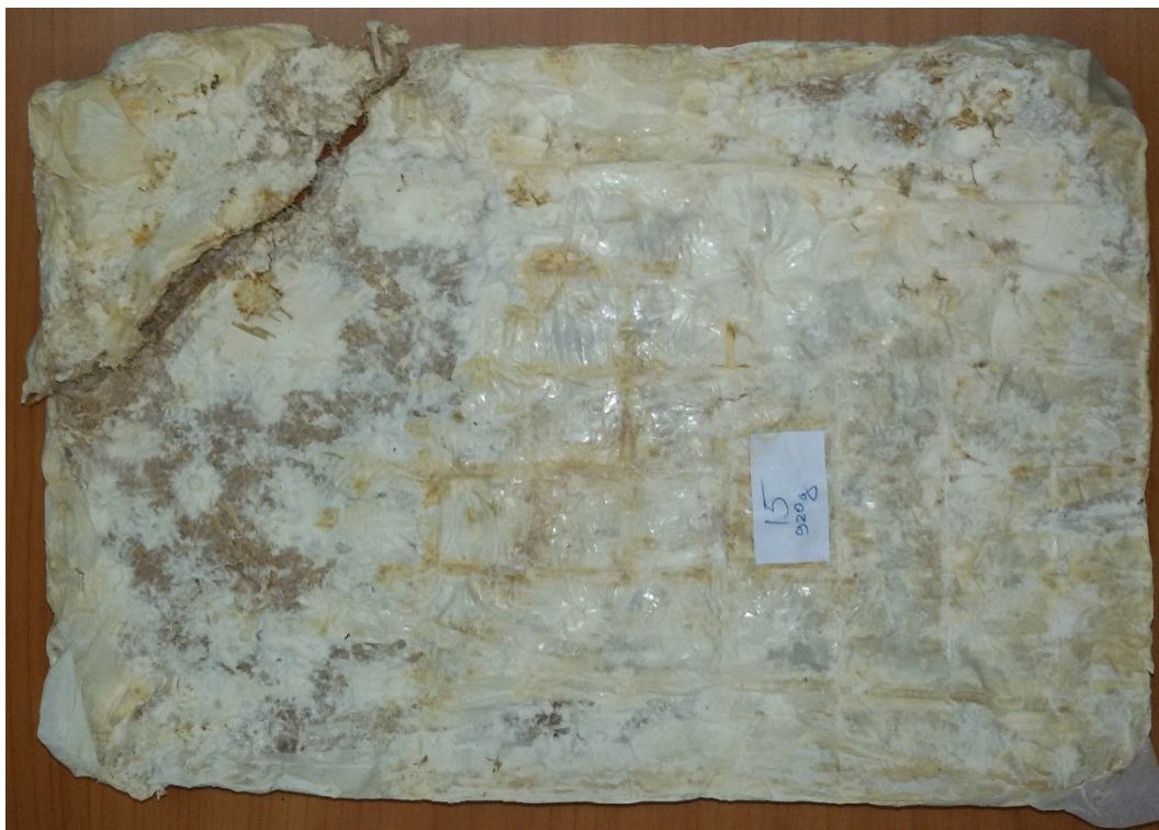
Сл. 3.3: Пример оштећења насталог приликом руковања материјалом услед сувише велике кртости
