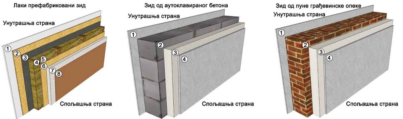
Сл. 2.5: Слојеви конструкције спољног зида модела за поређење енергетске ефикасности ТИ материјала
