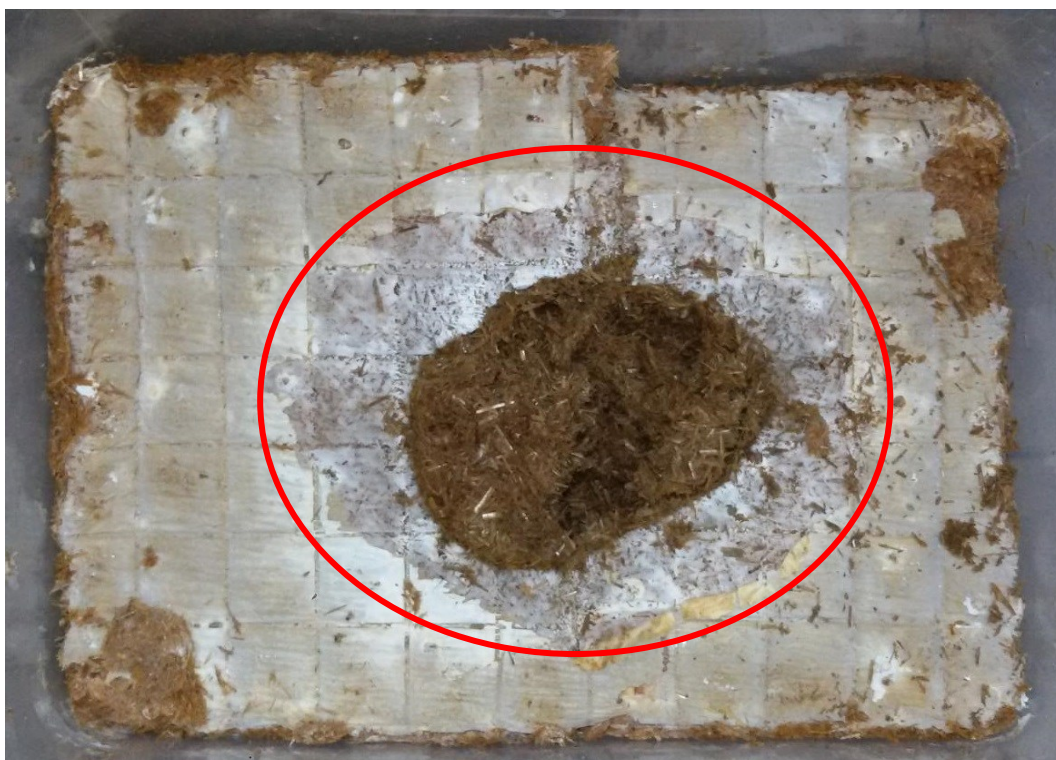
Сл. 3.4: Пример неуспешног узорка биокompозита са супстратом дужине до 8 mm. Развој мицелијума инхибиран у централном делу узорка услед формирања анаеробних услова средине (означено црвеним кругом)
