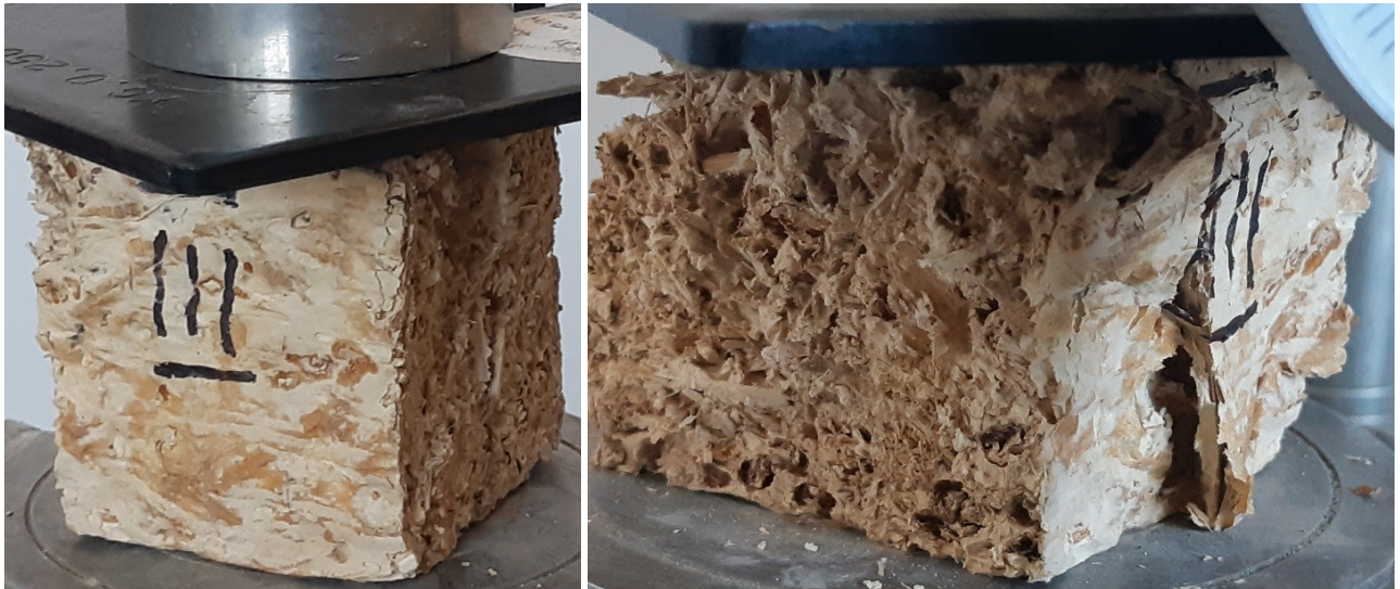
Сл. 3.19: Приказ узорка биокомпозита са конопљом оптерећеног при притиску у правцу простирања влакана пре (слика лево) и након теста (слика десно)
