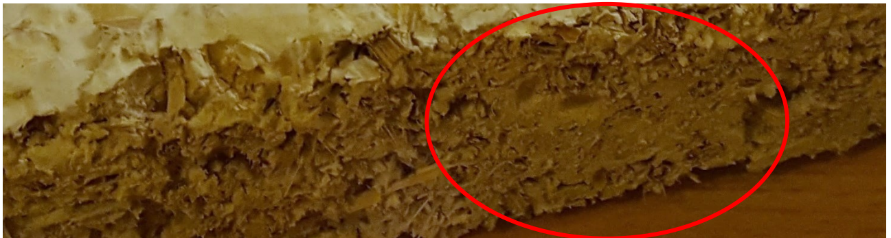
Сл. 3.7: Попречни пресек узорка биокомпозита са конопљом, мицелијумом и перлитом након сушења
