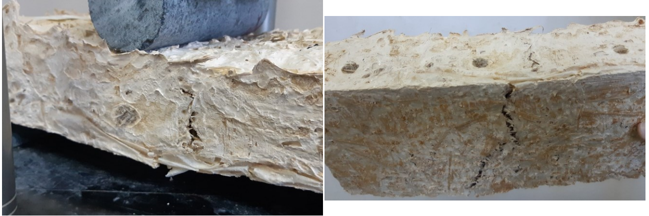
Сл. 3.21: Приказ лома приликом испитивања чврстоће при савијању биокompозита са конопљом
