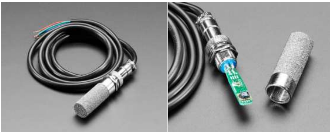
Слика 14: Изглед SHT15 сензора са и без заштитног дела, слика преузета са:
