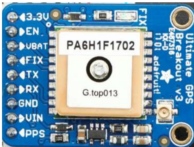
Слика 23: Изглед одабраног Adafruit GPS модула, слика преузета са: https://www.adafruit.com/product/746
