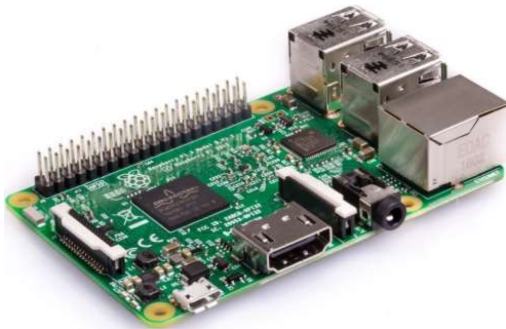
Слика 5: Изглед Raspberry Pi плоче треће генерације, слика преузета са https://www.raspberrypi.org/products/raspberry-pi-3-model-b/
