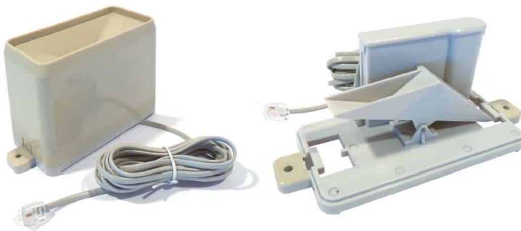
Слика 17: Изглед унутрашњости уређаја за мерење количине падавина, слика преузета са: https://projects.raspberrypi.org/en/projects/build-your-own-weather-station/9
