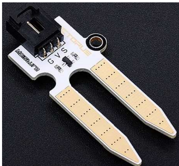
Слика 20: Octopus сензор влажности земљишта, слика преузета са: https://www.elecfreaks.com/store/octopus-soil-moisture-sensor-brick.html
