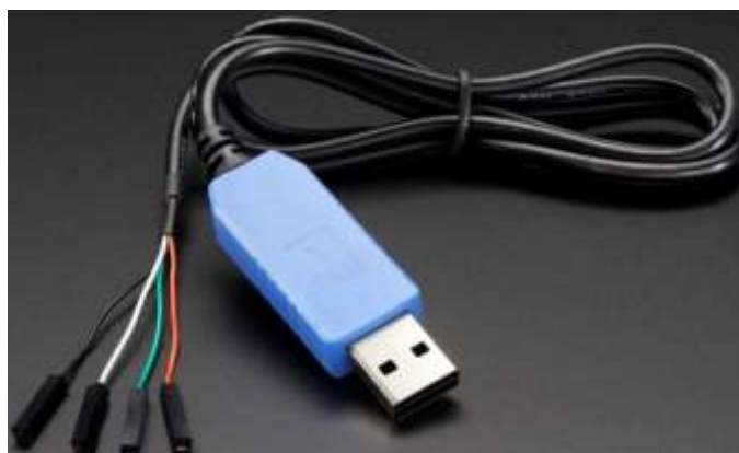
Слика 26: Изглед USB на TTL адаптера, слика преузета са: https://www.adafruit.com/product/954
