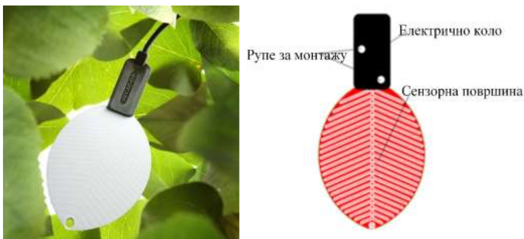
Слика 22: Изглед и шема Decagon сензора, слика преузета са: http://www.ictinternational.com/products/lws/phytos-31-leaf-wetness-sensor/
