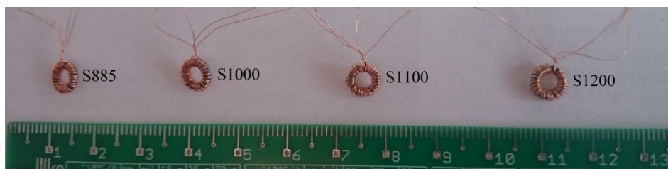
Slika 4.7 Predloženi ESL 40011 uzorci sa bifilarnim zavojcima prilikom merenja gustine snage gubitaka
