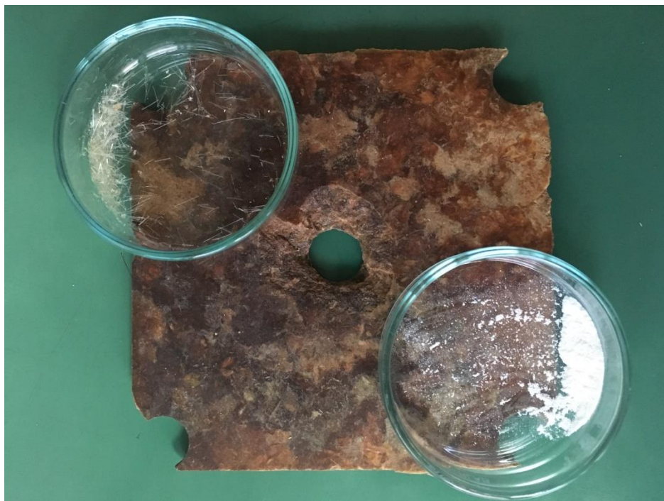
Slika 5.23 Hibridni WPC uzorak ojačan PET vlaknima i česticama \text{Al}_2\text{O}_3 nakon udara
