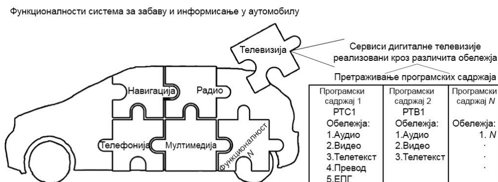
Слика 2.1 Проширење система за забаву и информисање у аутомобилу сервисима дигиталне телевизије
