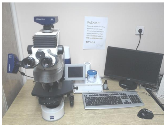
Slika 15. Carl Zeiss AxioImager.M1 mikroskop sa digitalnom kamerom AxioCam MRc5.
