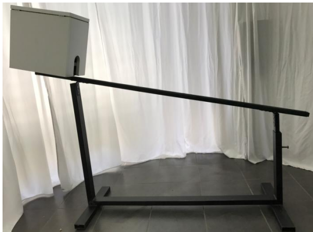
Слика 3.3. Апаратура за извођење тестова ходања по греди.
