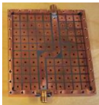
Slika 3.4 Realizacija jednostavne linijske tranzicije sa SMA konektora na mikrostrip grebenasti talasovod na bazi procepa, prikazan bez gornje provodne ploče, [22]
