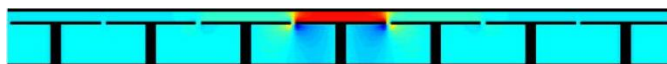
Slika 4.5 Normalna komponenta električnog polja moda prostiranja mikrostrip grebenastog talasovoda na bazi procepa na učestanosti od 11.6 GHz
