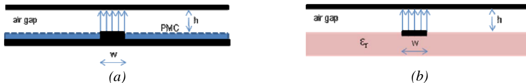
Slika 2.7 Poređenje talasovoda na bazi procepa sa invertovanim mikrostrip vodom: (a) idealni talasovod na bazi procepa, (b) invertovani mikrostrip vod, [12]
