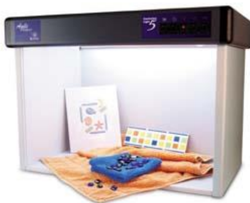
Slika 7.60: Kabinet za posmatranje uzoraka - Agile Radiant Controlled Light 5 (Ihara, 2016)
