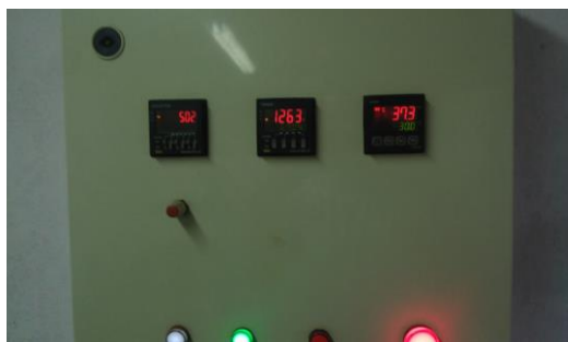
Slika 7.34: Uređaj za regulaciju brzine kretanja lopatica, vremena hemijskog nagrivanja i temperature sredstva za nagrivanje
