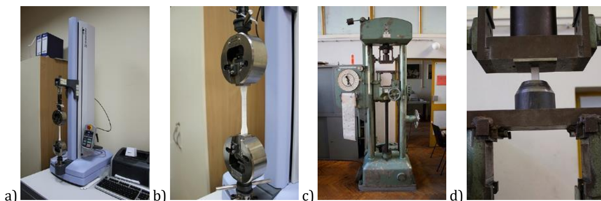
Slika 7.16: a) mašina za testiranje zatezne čvrstoće Shimadzu Compact Tabletop Testing Machine EZ-LX; b) uveličan prikaz ćeljasti za pričvršćavanje uzoraka; c) mašina za testiranje pritisne čvrstoće VEB ZDM 5/91; d) uveličan prikaz ploča za pritiskanje uzoraka
