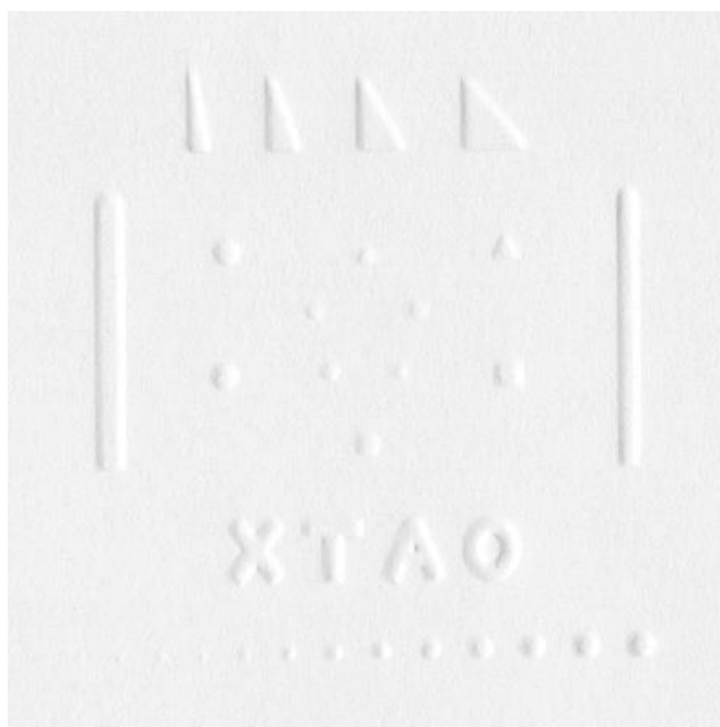
Slika 9.3: Prikaz skeniranog uzoraka papira utisnutog alatom izrađenim SLA tehnikom 3D štampe
