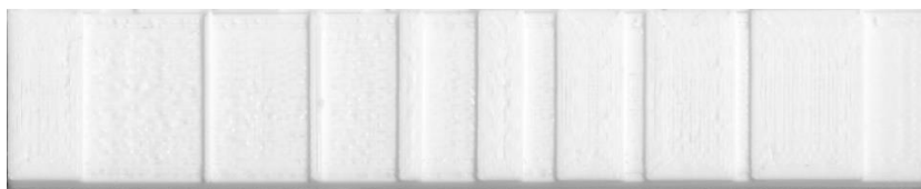
Slika 7.45: Odštampan uzorak za definisanje termalne ekspanzije PLA materijala nakon štampe FDM tehnikom 3D štampe
