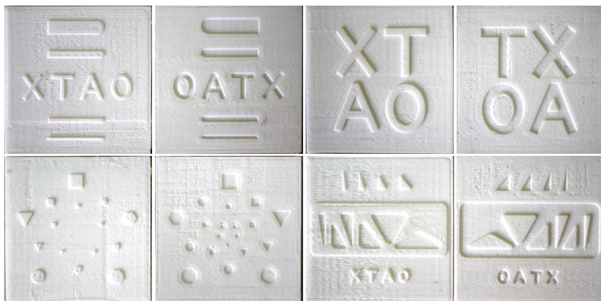
Slika 7.49: Komplet alata izrađenih FDM tehnikom 3D štampe
