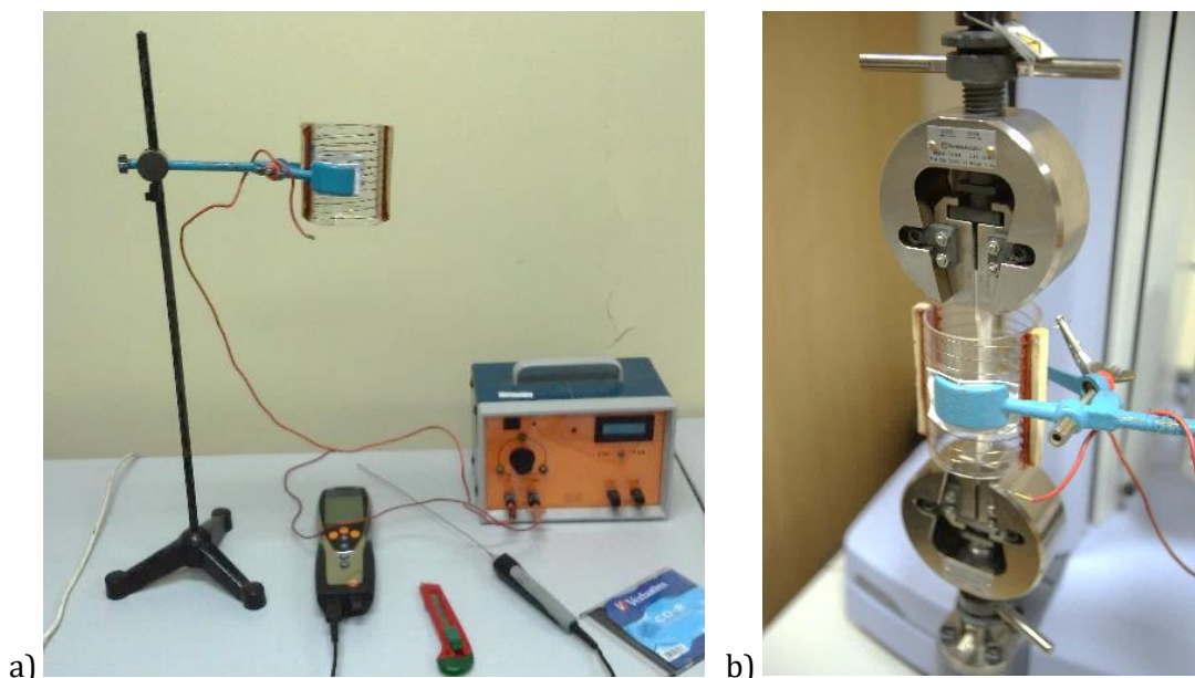
Slika 7.18: a) Aparatura za zagrevanje uzorka tokom testiranja zatezne čvrstoće i b) montirana aparatura na čeljusti za fiksiranje uzorka prilikom testiranja zatezne čvrstoće
