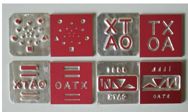
Slika 7.35: Komplet alata izrađenih tehnikom hemijskog nagrivanja magnezijuma namenjenih za istraživanje obuhvaćeno doktorskom disertacijom
