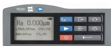
Slika 7.8: Uređaj za merenje površinske hrapavosti TR200 - Time Group Inc, China (RP Electronics, 2017)
