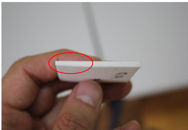
Slika 9.2: Deformacija u donjem delu alata za utiskivanje izrađenog FDM tehnikom 3D štampe – mogući uzrok nejednačene visine utisnutih elemenata
