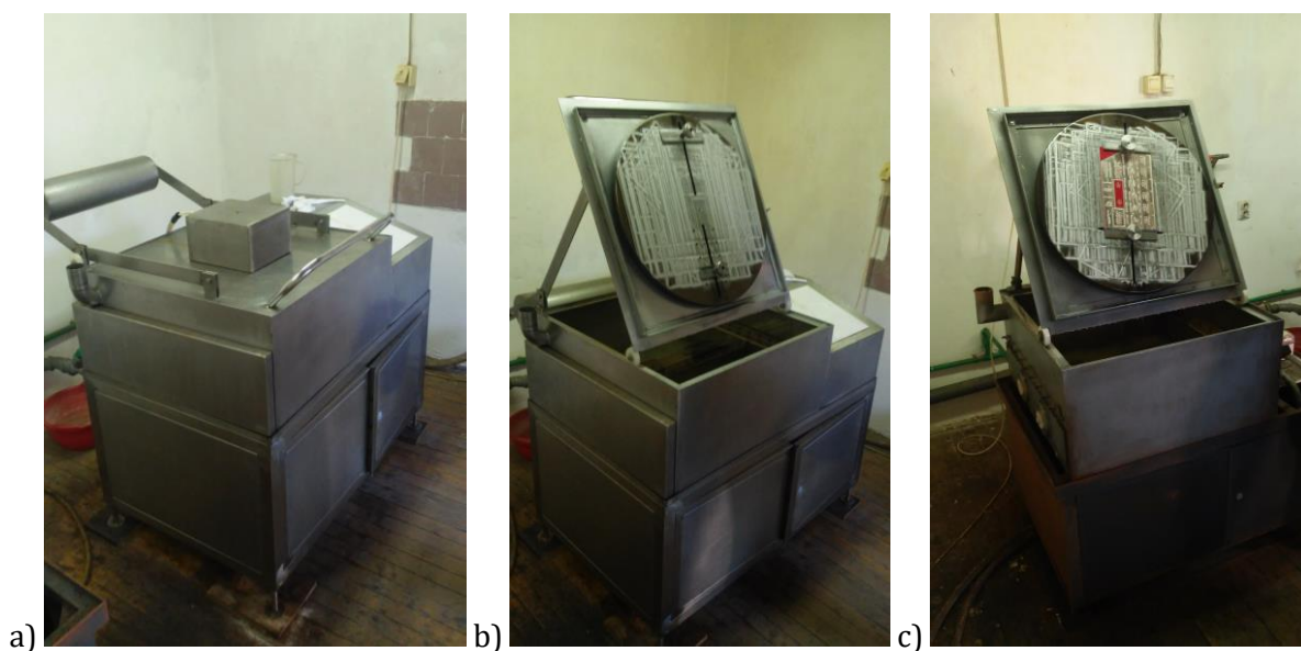
Slika 7.33: Uređaj za hemijsko nagrivanje magnezijumskih ploča i fiksiranje ploče spremne za proces hemijskog nagrivanja
