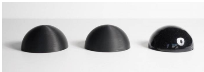
Slika 3.23: (S leva na desno) Neobrađen uzorak izrađen FDM tehnikom 3D štampe, mehanički obrađen uzorak i hemijski obrađen uzorak (Armstrong, 2018)
