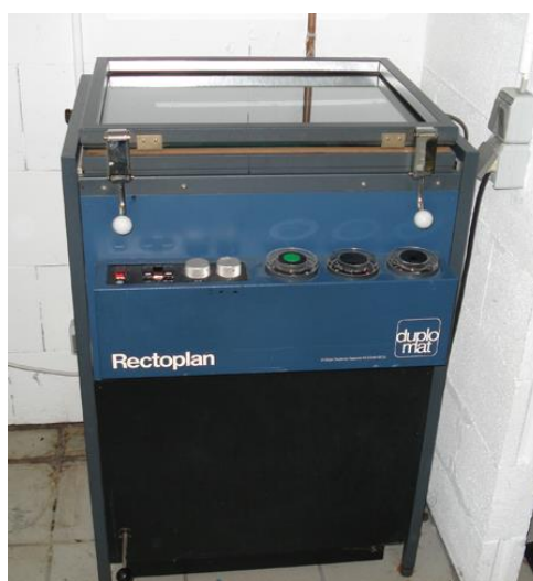
Slika 7.31: Uređaj za osvetljavanje ploča Rectoplan Duplomat
