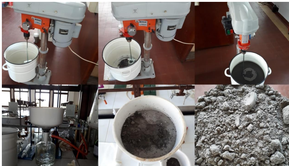
Slika 6. Prikaz uklanjanja As(V) na MFA - poluindustrijsko ispitivanje
