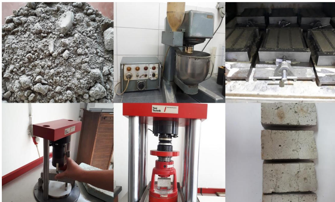
Slika 7. Prikaz ispitivanja mehaničkih svojstava građevinskog materijala CM-MFA/As(V)
