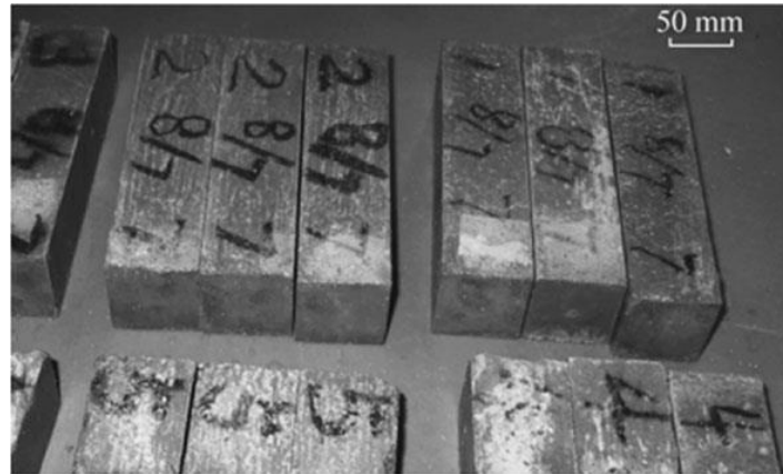
Slika 2. 10. Cigle proizvedene upotrebom NMF frakcije [72]
