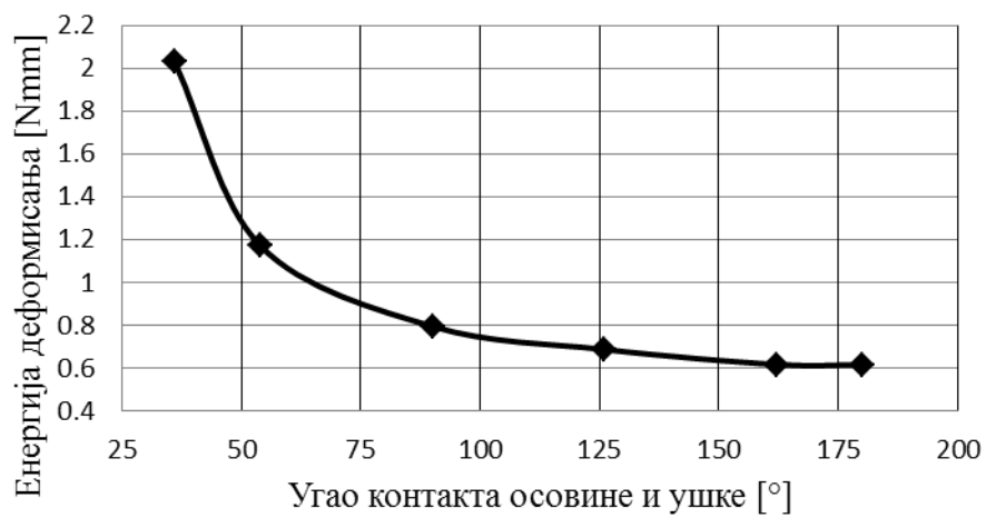
Слика 4.63 Дијаграм зависности апсолутне енергије деформисања од укупног угла контакта осовине и ушке модела U8
