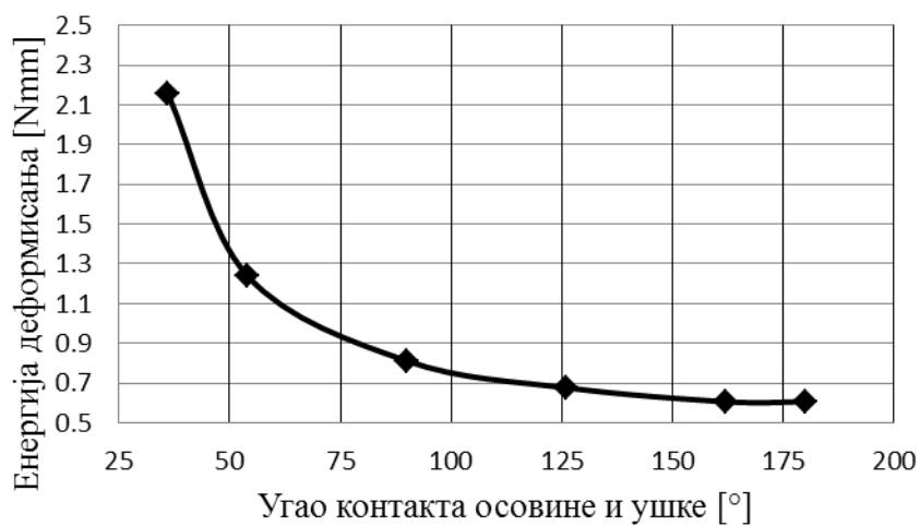
Слика 4.18 Дијаграм зависности апсолутне енергије деформисања од укупног угла контакта осовине и ушке
