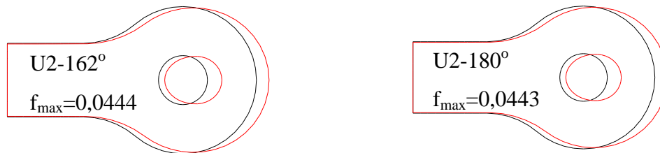
Слика 4.20 (наставкак) Деформисани облик модела U2 са максималним померањем y [mm]
