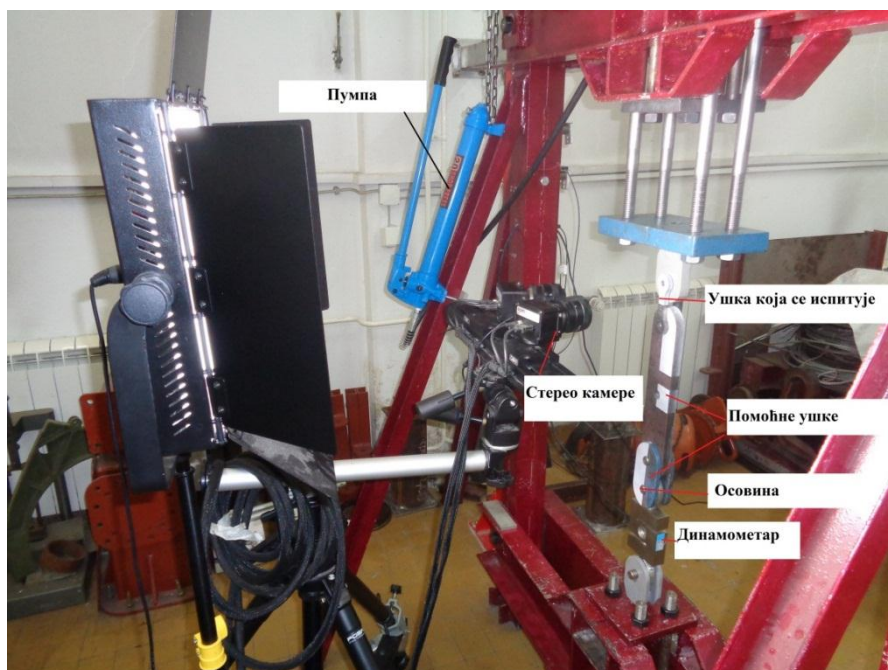
Слика 5.10 Распоред мерне опреме
