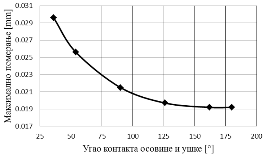
Слика 4.61 Дијаграм зависности максималног померања од укупног угла контакта осовине и ушке модела U8
