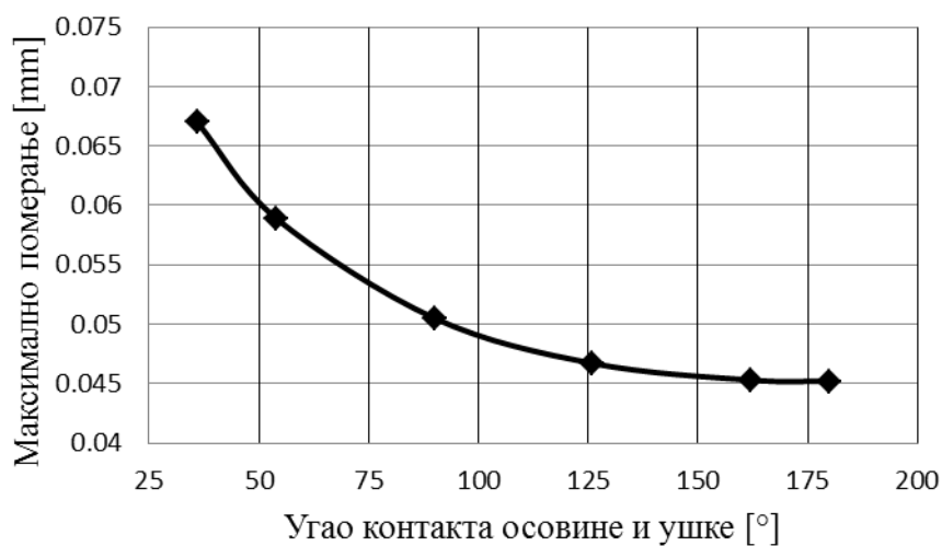
Слика 4.32 Дијаграм зависности максималног померања од укупног угла контакта осовине и ушке модела U3
