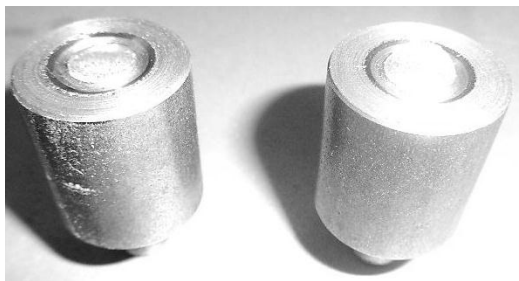
Слика 5.13 Лом осовина при чистом смицању
