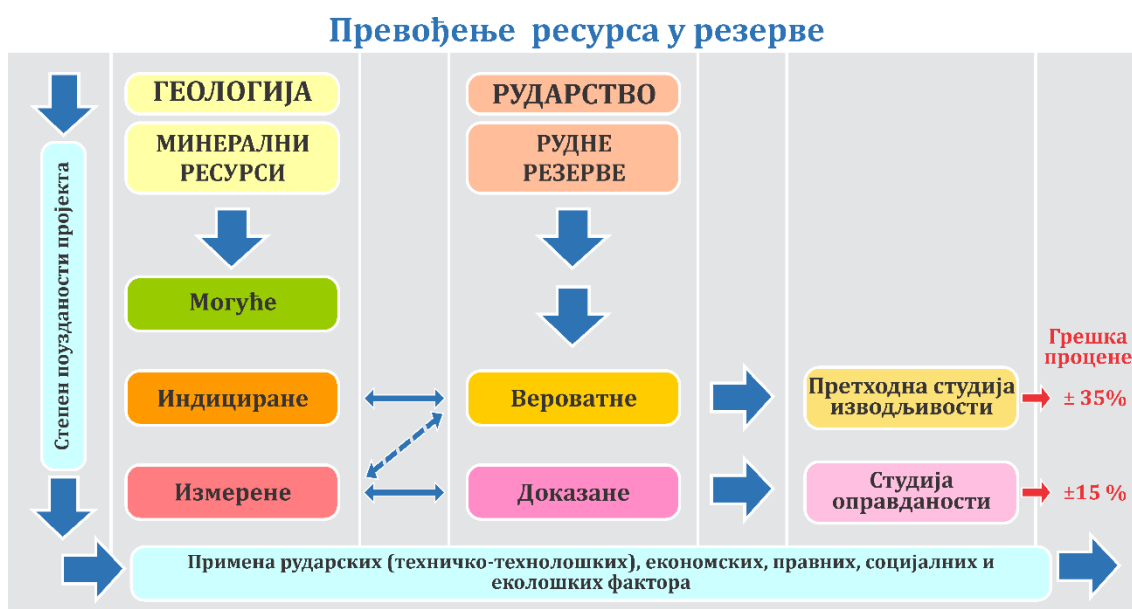
Слика 4.2. Веза између минералних ресурса и минералних резерви
