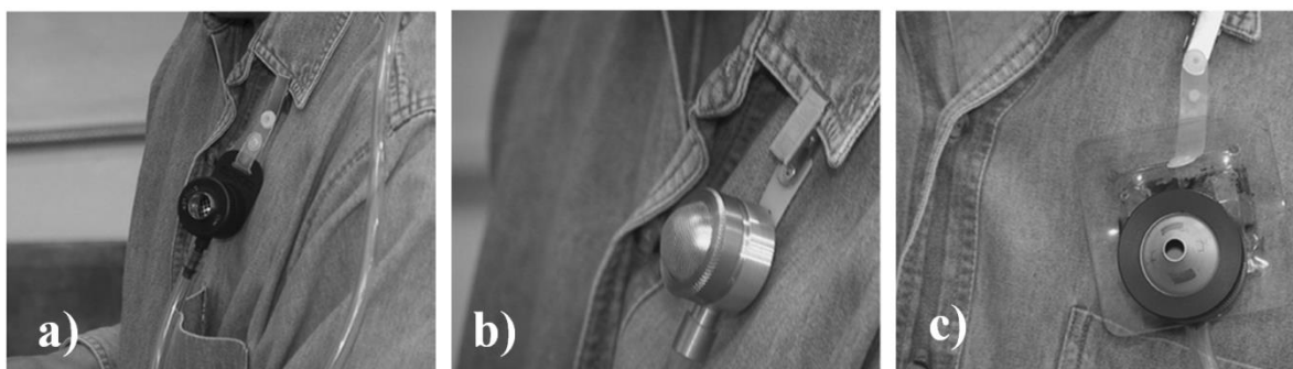
Slika 2.5 Personalni uzorkivači: a) IOM; b) Button; c) GIS (Harper i dr., 2004)
