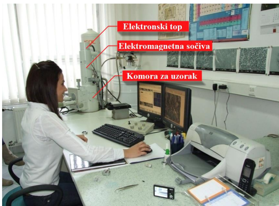
Slika 2.11 Analiza na skenirajućem elektronskom mikroskopu JEOL JSM - 5610
