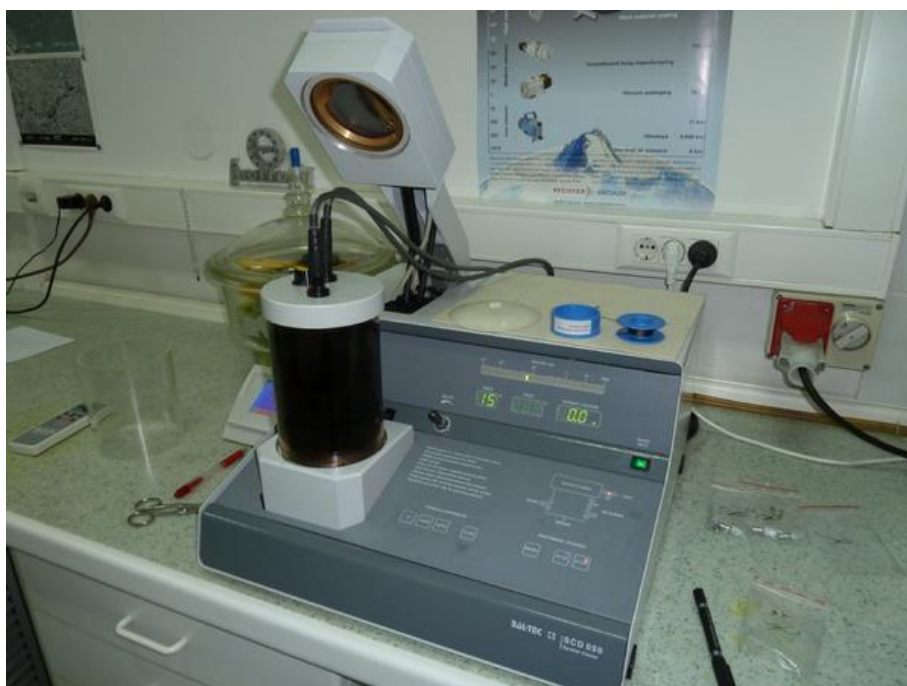
Slika 2.12 Uređaj za naparivanje uzorka Sputter Coater Balzers SCD 050
