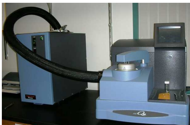
Slika 3.8. Diferencijalni skanirajući kalorimetar, DSC Q100, TA Instruments
