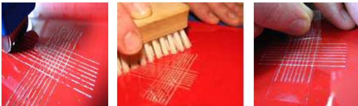
Slika 3.13. Postupak ispitivanja stepena prijanjanja filma premaza
