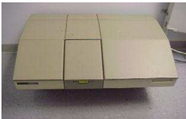
Slika 3.3. IR spektrofotometar sa Furijeovom transformacijom, FTIR Perkin Elmer, Waltham, MA Spectrum-1000
