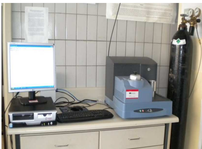
Slika 3.6. Diferencijalni skanirajući kalorimetar, DSC Q20, TA Instruments
