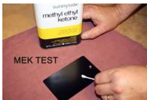
Slika 3.18. Određivanje postojanosti na metiletilketon (MEK test)
