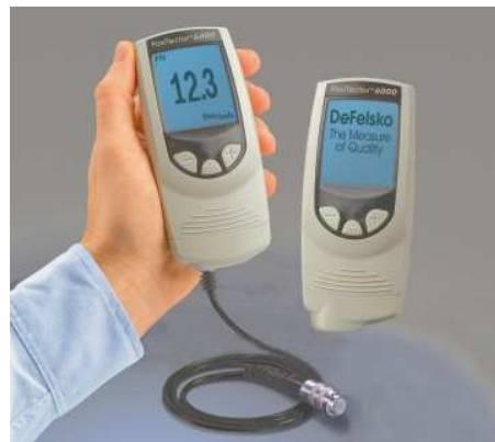
Slika 3.11. Instrument za merenje debljine filma premaza, Defelsko PosiTector 6000 FSN2
