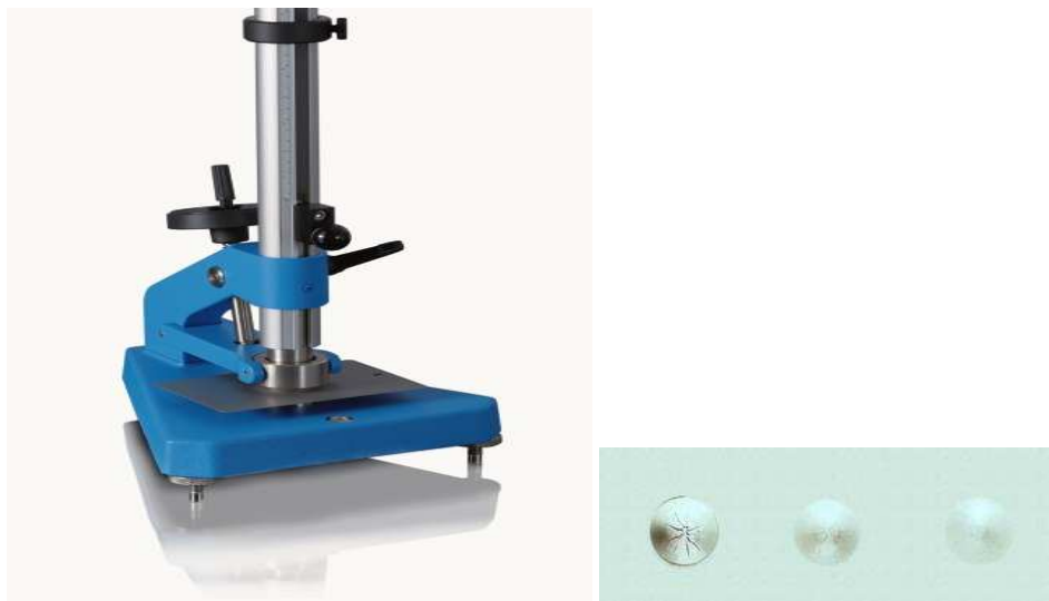
Slika 3.17. Aparat za određivanje otpornosti na udar po Erichsen-u i tipična slika filma na kraju eksperimenta
