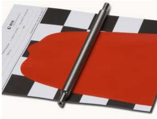
Slika 3.10. Šipka za nanošenje filma premaza
