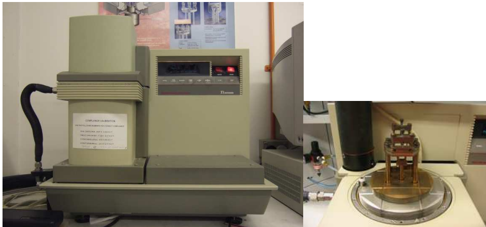
Slika 3.9. Instrument za dinamičko mehaničku analizu, DMA 2980 TA Instruments i slika kleme za koju se pričvrsti uzorak
