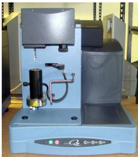
Slika 3.7. Instrument za termogravimetrijsku analizu, TGA Q50, TA Instruments
