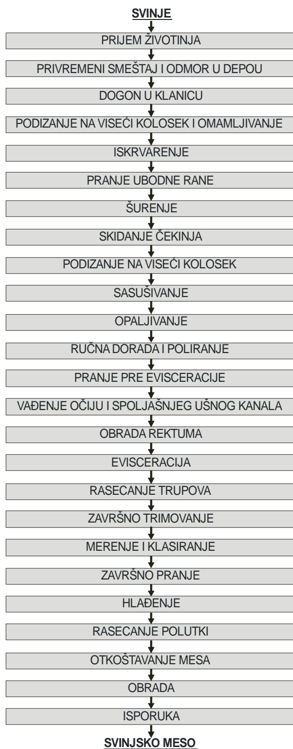
Slika 2.3.5. Dijagram toka proizvodnje klasiranog svinjskog mesa namenjenog preradi u industrijskim objektima za proizvodnju mesa u Srbiji
