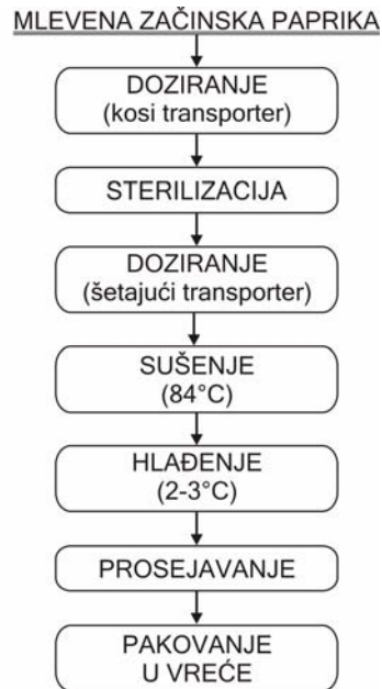
Slika 26. Šema sterilizacije mlevene začinske paprike u fabrici "Aleva" iz Novog Kneževca
