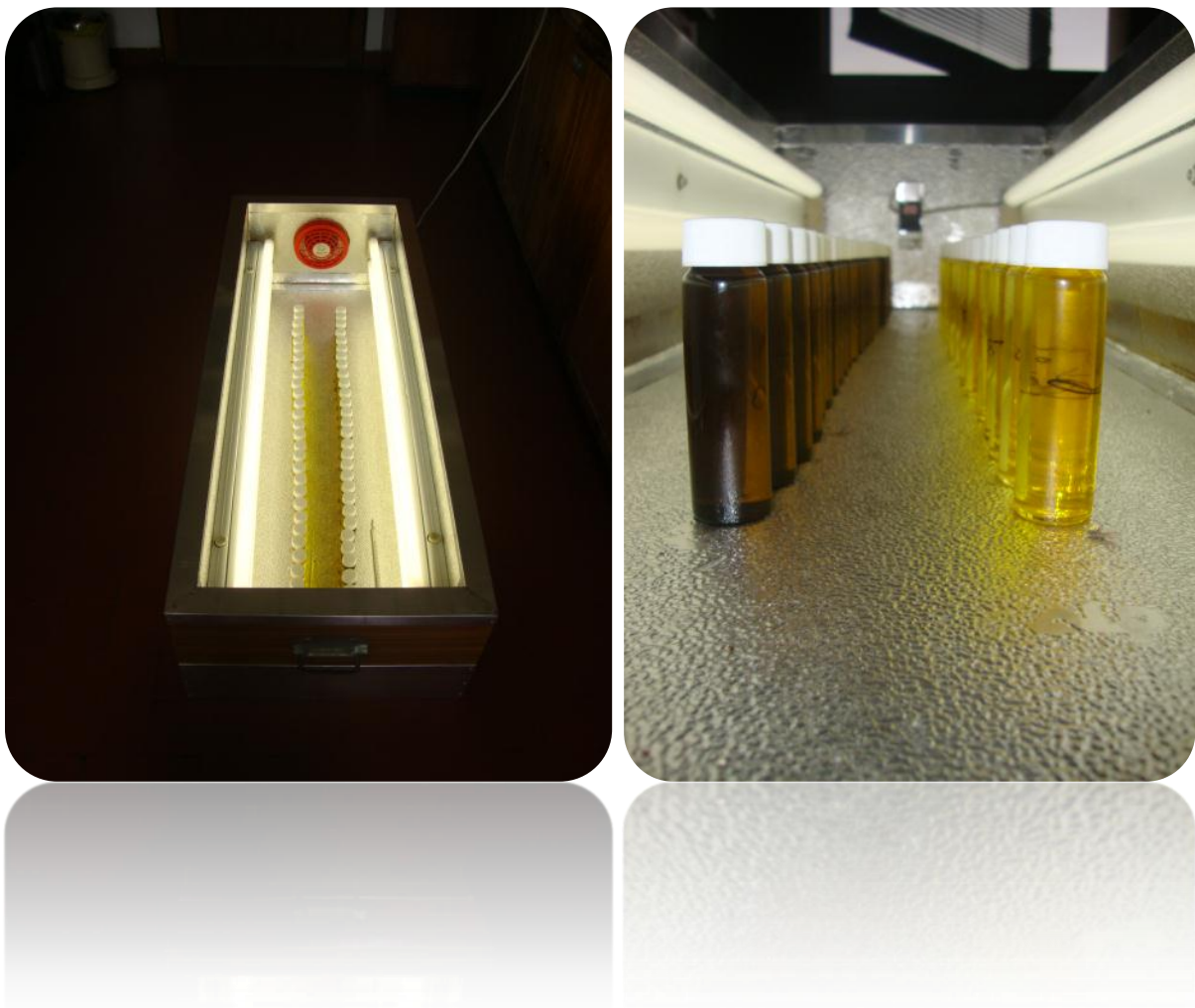
Slika 38. Uslovi osvetljenja uzoraka fluorescentnim svetlom
