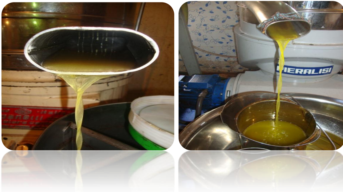
Slika 36. Separacija/izdvajanje ulja pomoću separatora
