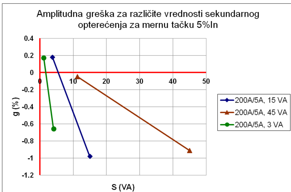
Slika 3.1.5 Amplitudna greška u funkciji sekundarnog opterećenja i ispitne struje kao parametara (za mernu tačku 5% I_n ), za merne transformatore klase tačnosti 0.5, prenosnog odnosa 200 A/5 A i različitih naznačenih snaga: 3 VA, 15 VA i 45 VA [118]
