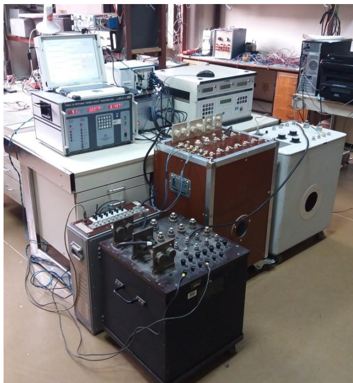
Slika 2.5.2 Realizacija jednovremene uporedne metode etaloniranja kod poređenja tri merna sistema u Laboratoriji Elektrotehničkog instituta „Nikola Tesla“
